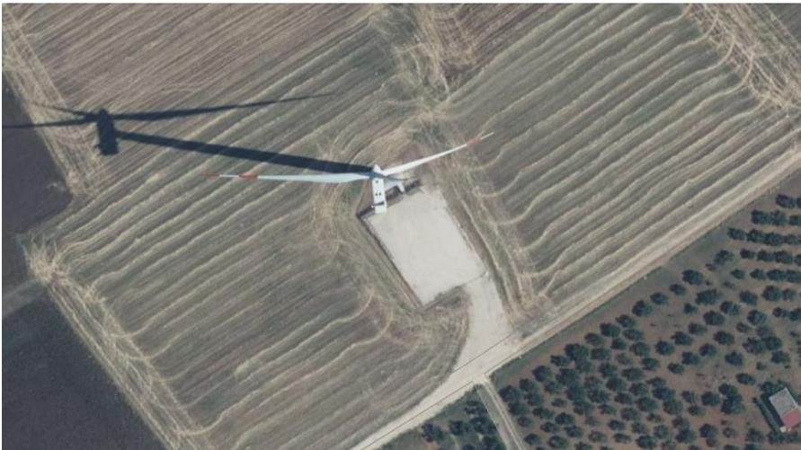
*Figura 4: Replica esatta della foto satellitare precedente, scattata l'anno successivo, con piazzola ridotta e ripristino dell'uso del suolo agricolo*
