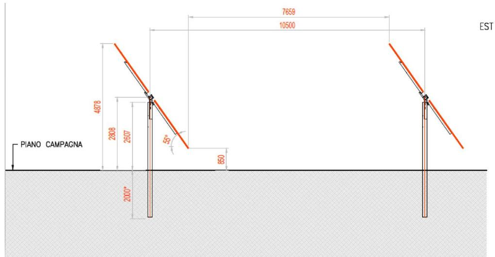
Figura 3.2: Particolare strutture di sostegno moduli
