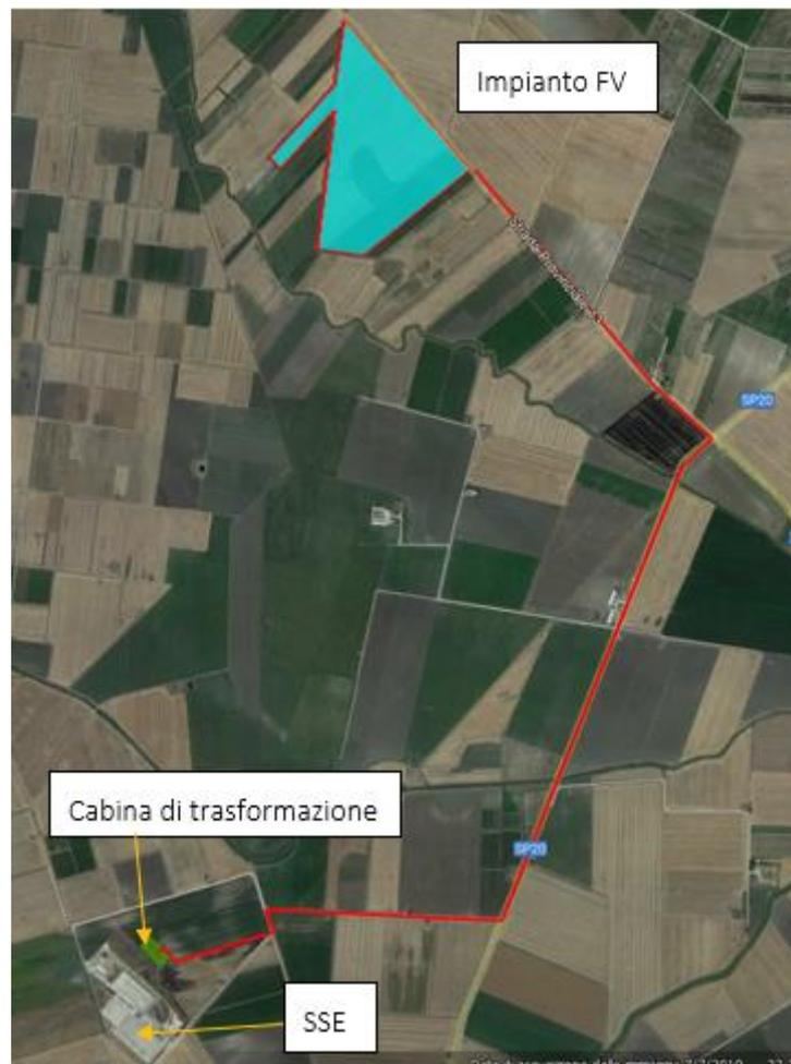
Figura 3.7: In ROSSO il percorso di connessione dal campo FV alla cabina di trasformazione
