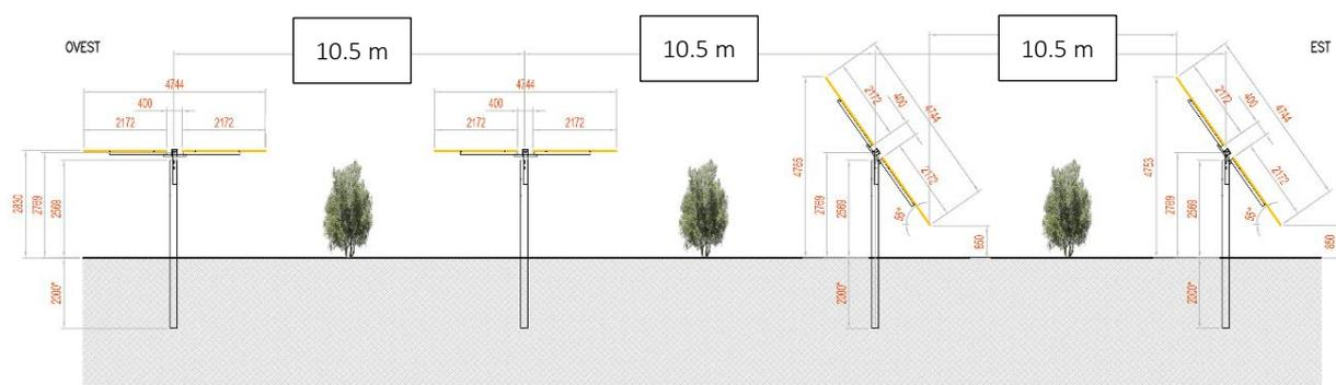
Figura 3.11: Tipologico – Sezione trasversale dell'impianto Olivicolo
