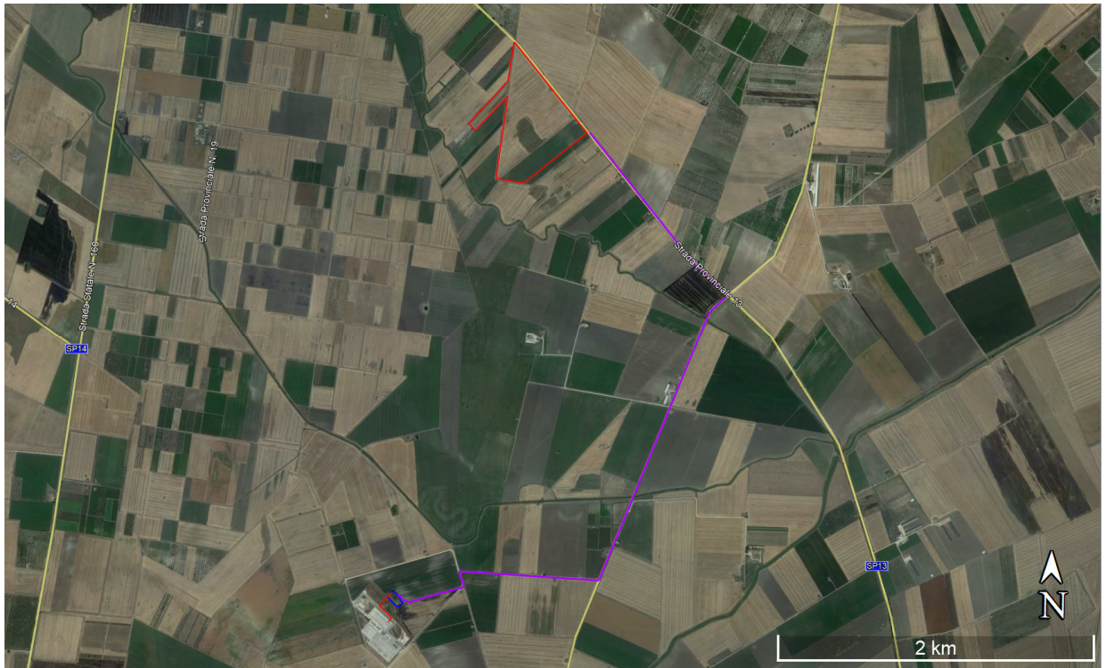
Figura 3.1: Inquadramento territoriale. In rosso il perimetro del sito, in viola il percorso di connessione alla RTN.
