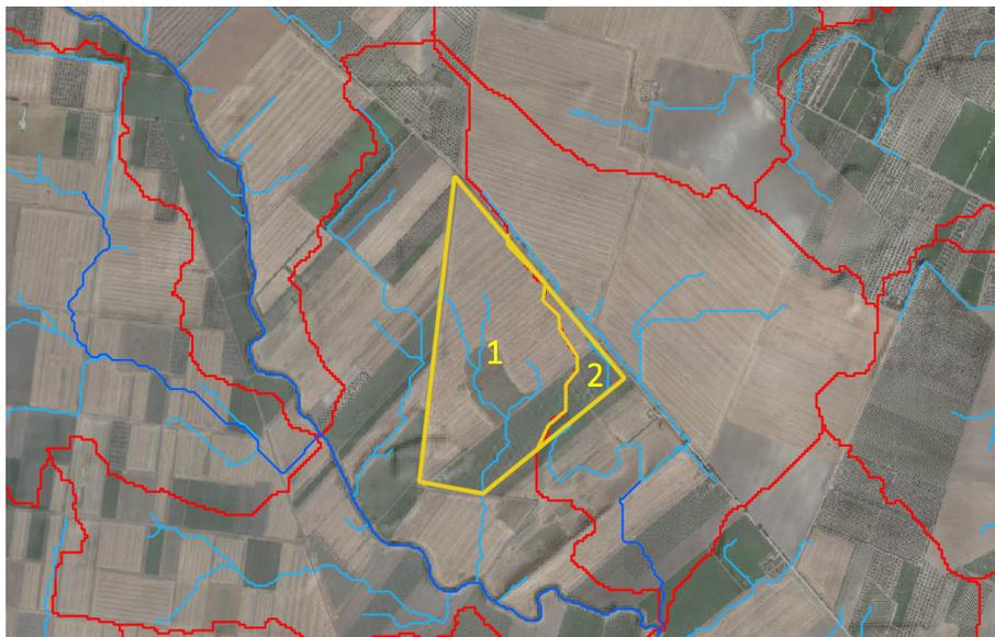
Figura 5.9: Delimitazione recinzione di impianto (giallo), rete di drenaggio naturale interna (blu) e spartiacque (rosso).
