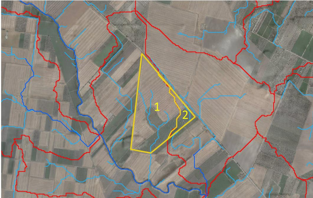
Figura 5.5: Delimitazione bacini scolanti e codifica (giallo), reticolo di drenaggio esterno ed interno alle sezioni di progetto (blu) e limiti bacini idrografici (rosso).
