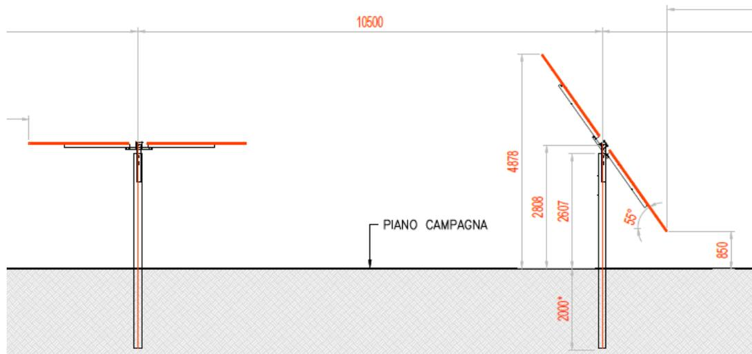
Figura 4.1: Particolare strutture di sostegno moduli, sezione trasversale.
