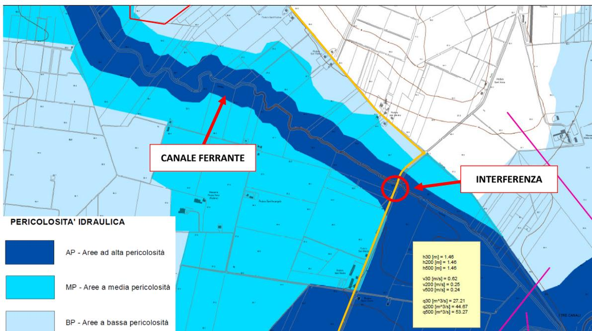
Figura 3.13: Stralci carta di pericolosità idraulica nr. 075 "San Severo" del PGRA aggiornata al 30/03/2016. In arancione il percorso di connessione.
