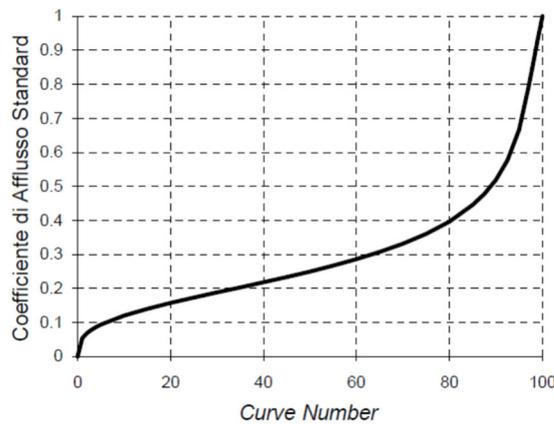
Figura 5.7: Correlazione da letteratura SCS-CN vs. coeff. afflusso/deflusso.
