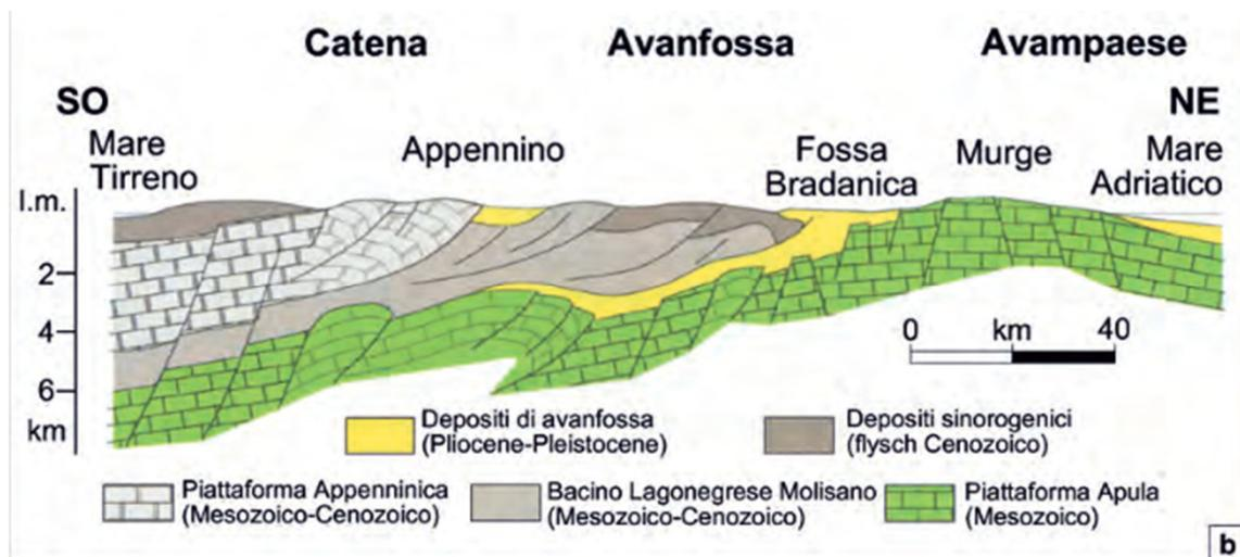
Figura 3.5: Sezione geologica schematica attraverso l'avanfossa appenninica.
