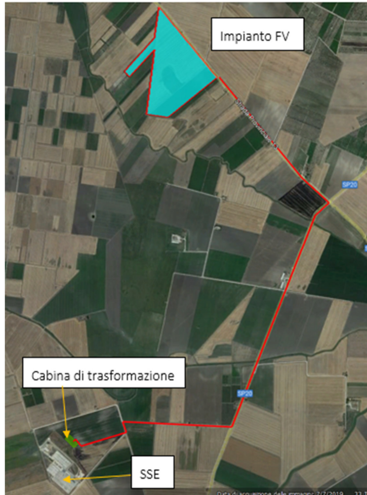
Figura 2.12: In ROSSO il percorso di connessione dal campo FV alla cabina di trasformazione
