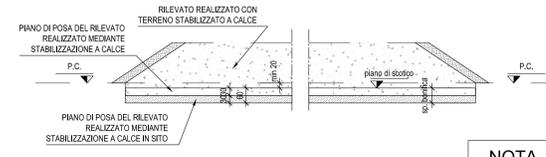
SEZIONE TIPO CON RILEVATO H > 1.00m
