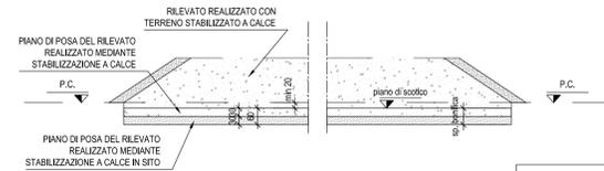
SEZIONE TIPO CON RILEVATO H > 1.00m
