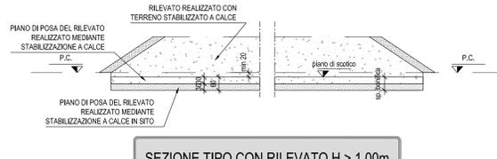
SEZIONE TIPO CON RILEVATO H > 1.00m
