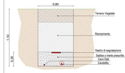
POSA CAVIDOTTO BT - SOTTO VIABILITA' INTERNA
