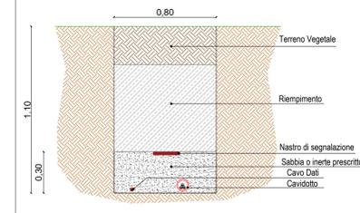
POSA CAVIDOTTO MT A 30KV - SOTTO VIABILITA' INTERNA
