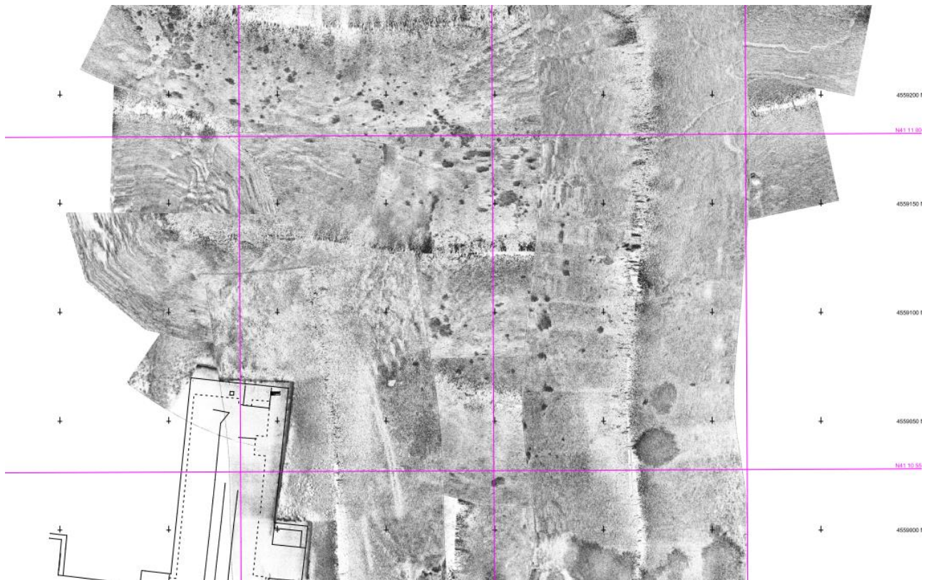
Figura 17: immagine ricavata dal rilievo side scan sonar
