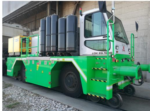
Illustrazione 26: Locotrattori elettrici attualmente in uso all'interno dello scalo ferroviario.
