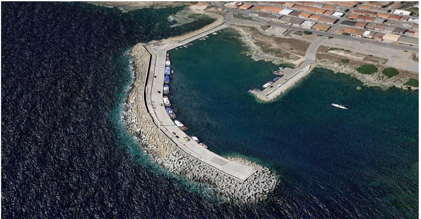
Il prolungamento di progetto prevede, in analogia all'esistente, l'impiego di altrettanti elementi prefabbricati in calcestruzzo "accropodi" maggiormente performanti e contestualmente meno ingombranti dal punto di vista geometrico, riducendo l'ingombro in pianta, dell'opera di protezione, a parità di *performance*.
