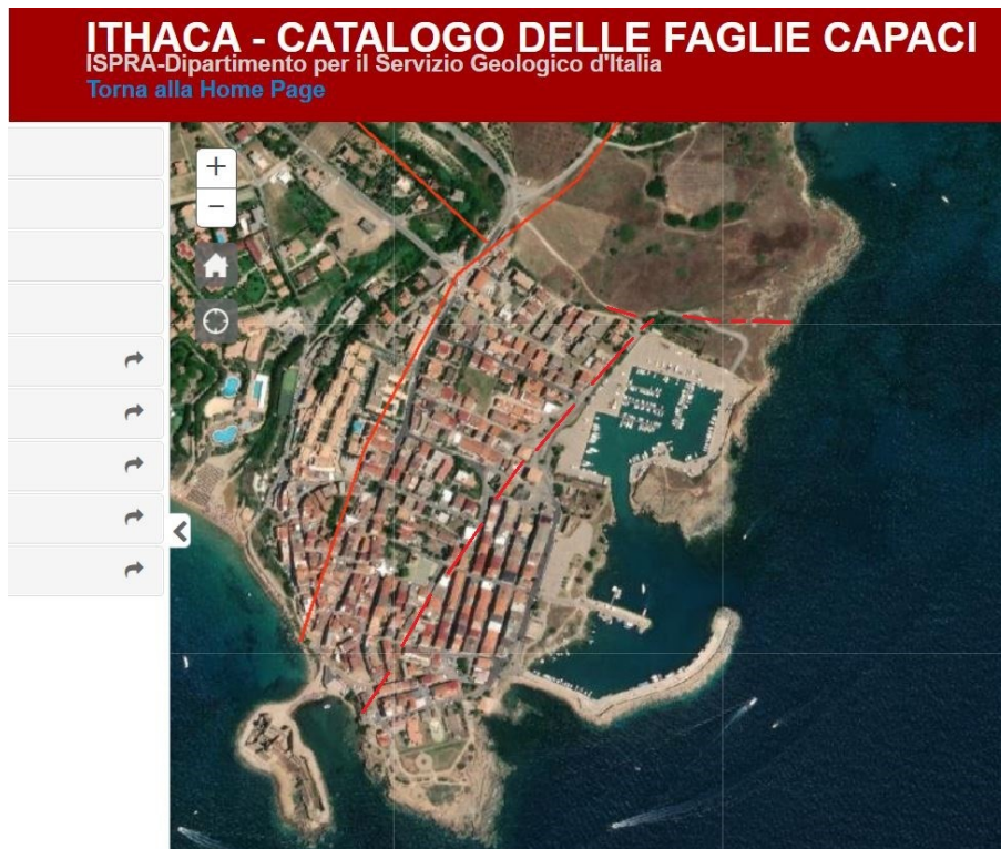
Fig. 6: Rappresentazione cartografica da “catalogo delle faglie capaci ITHACA”. Viene riportata con linea rossa (alto a sinistra) la faglia attiva e capace FAC presente a monte del sito di progetto e la faglia presunta ipotizzata con i rilievi geologi (linee tratteggiate) riportata su TAV B.03C Carta geologica allegata alla presente relazione
