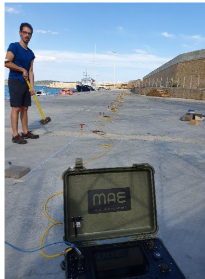
Foto n. 6 Esecuzione prova Down Hole (a sinistra) e sismica a rifrazione (a destra) su Stazione ST)
