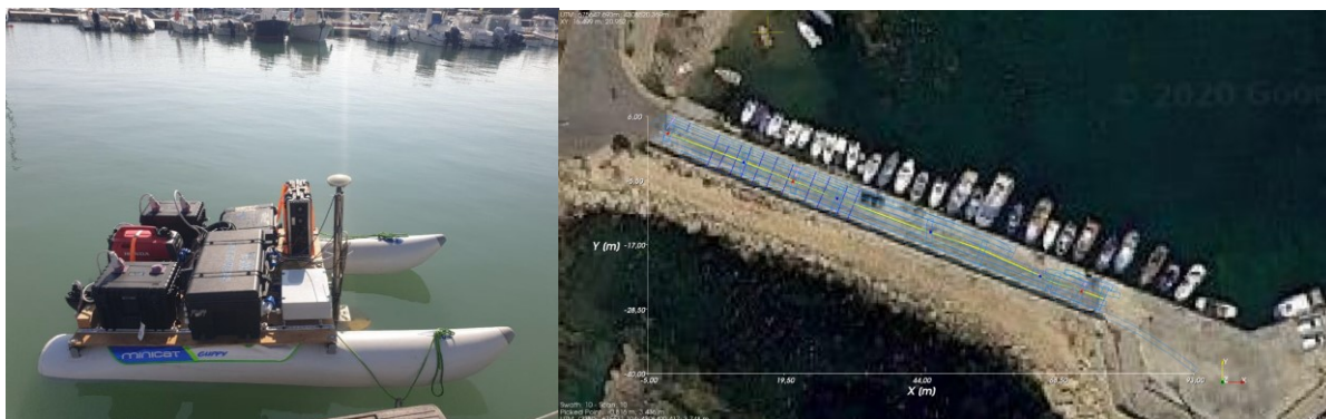
Foto n. 7 ASV Geodrone con strumentazione accessoria a bordo; a sinistra i profili swatch eseguiti mediante GPR paralleli e ortogonali alla banchina (Stazione ST2) radice molo sopraflutto
