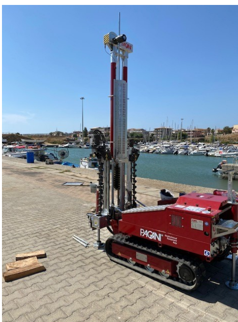
Foto n. 5 Posizionamento sonda TG-63 200 Pagani per esecuzione prova DPSH1
