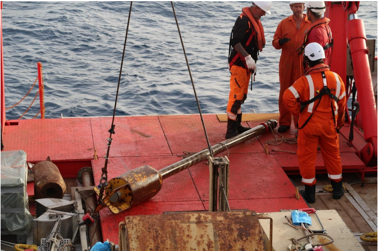
Figura 8.4 - Carotiere a gravità
