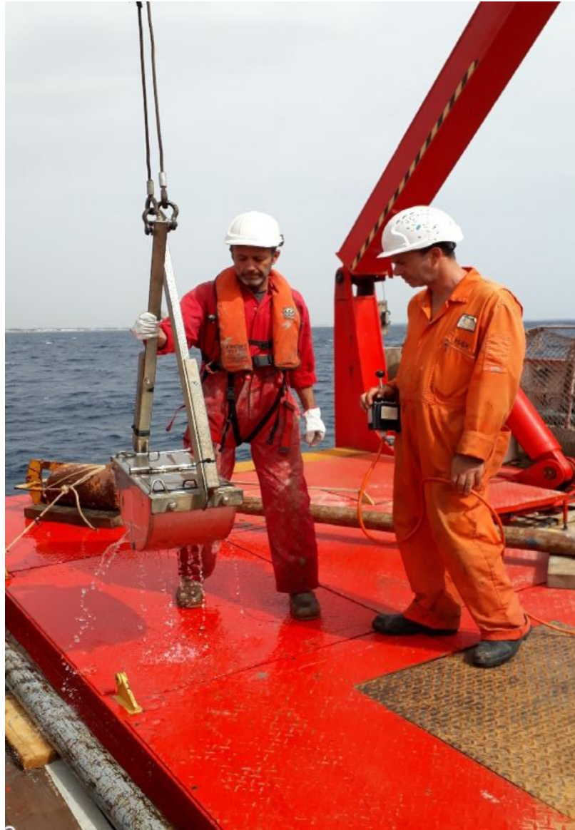
Figura 8.3 - Recupero della benna Van Veen a bordo
