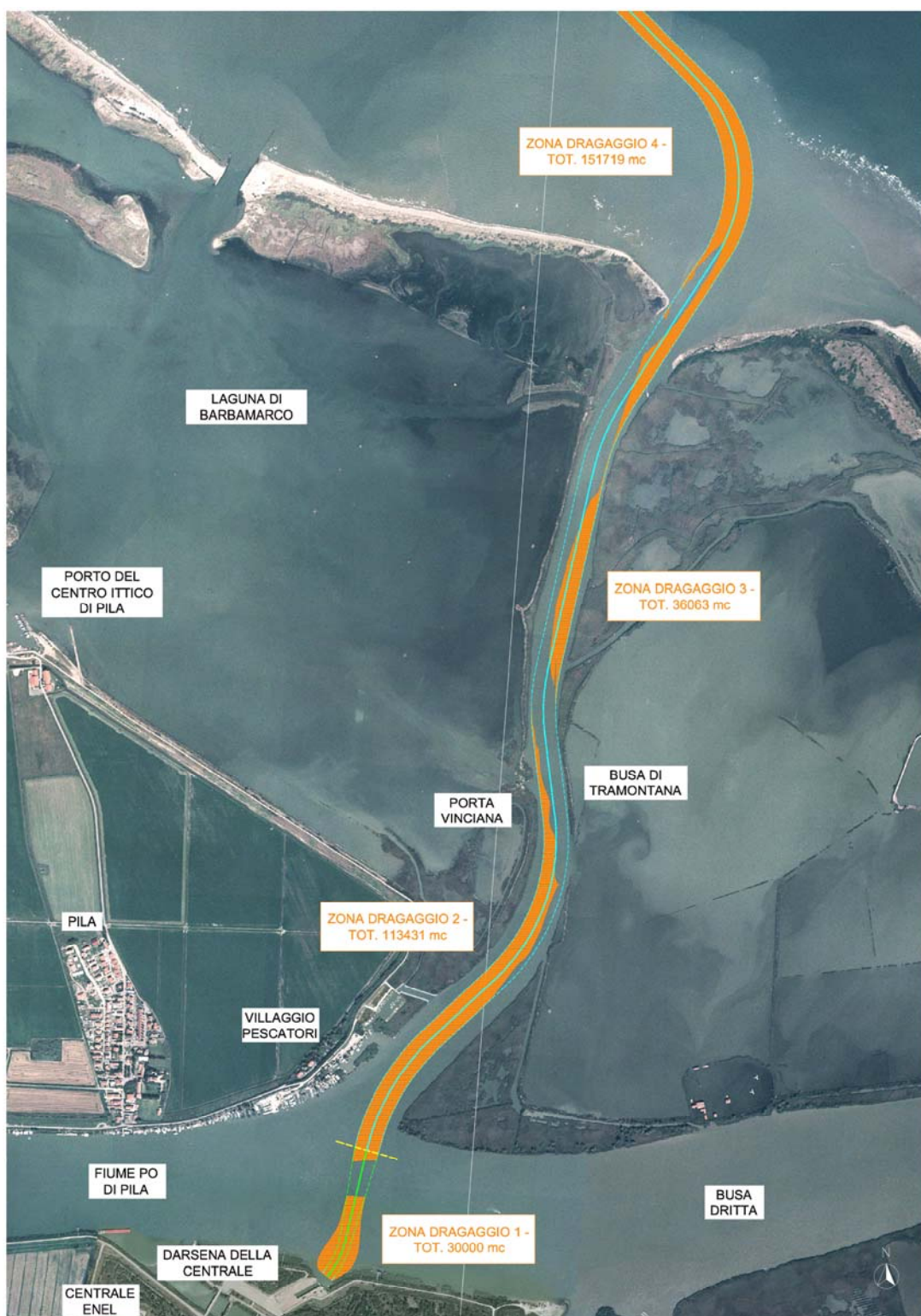
Figura 20 -Rappresentazione del percorso lungo la Busa di Tramontana con indicazione dei volumi da dragare per la realizzazione del canale di navigazione.
