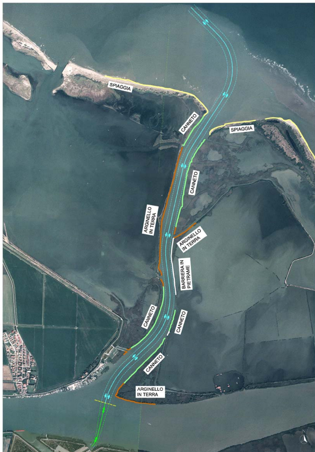
Figura 16 - la Busa di Tramontana: tipologia sponde.
