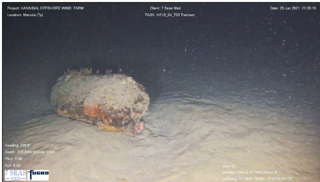
Figura 2.20: Frame dell'Ispezione Visiva registrata sul transetto H21S-04-T03 – possibile UXO
