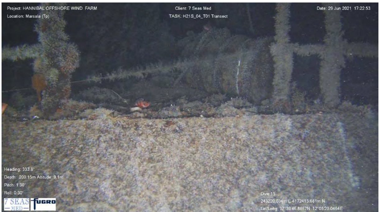
Figura 2.18: Frame dell'Ispezione Visiva registrata sul transetto H21S-04-T02 – cavo Artemis
