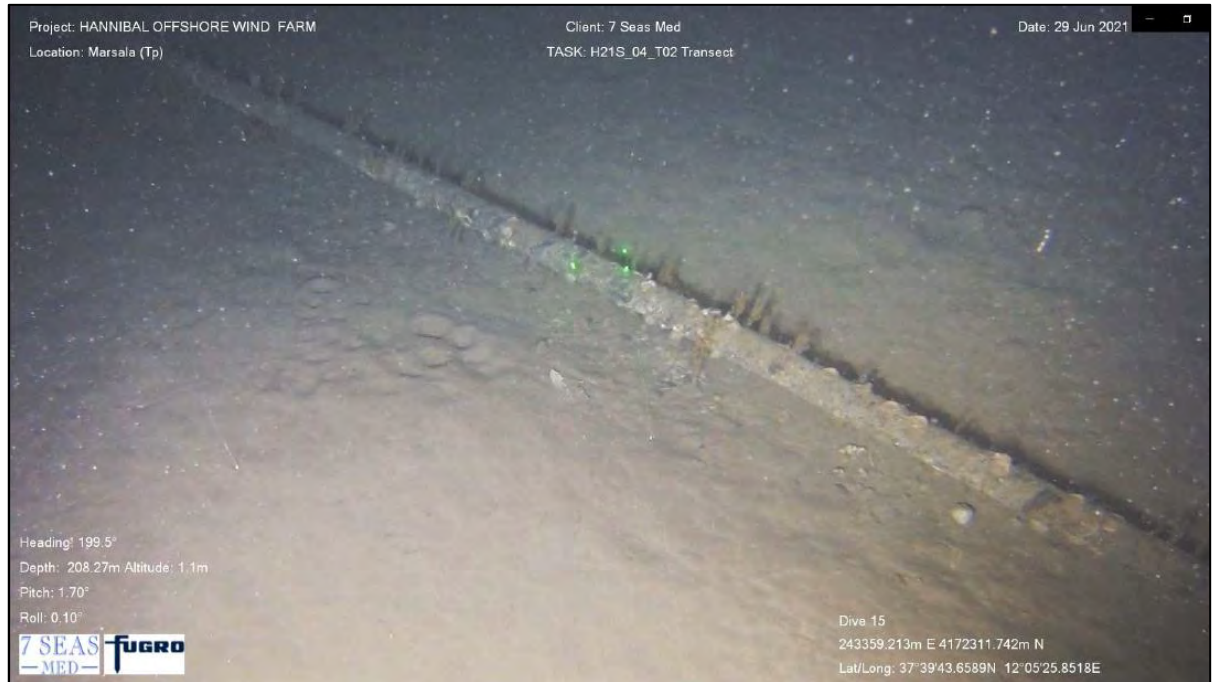
Figura 2.18: Frame dell'Ispezione Visiva registrata sul transetto H21S-04-T02 – cavo Artemis
