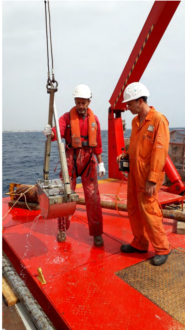
Figura 5.2: Recupero della benna Van Veen a bordo.
