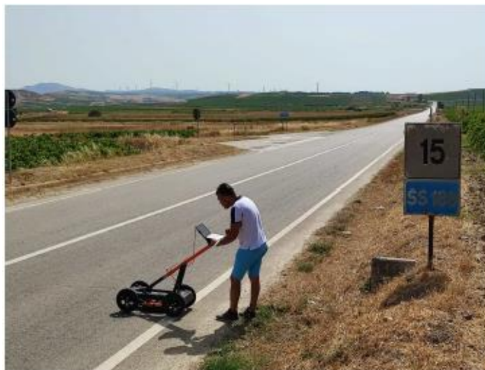
Figura 5.1 – Foto della campagna georadar lungo il percorso del cavidotto
