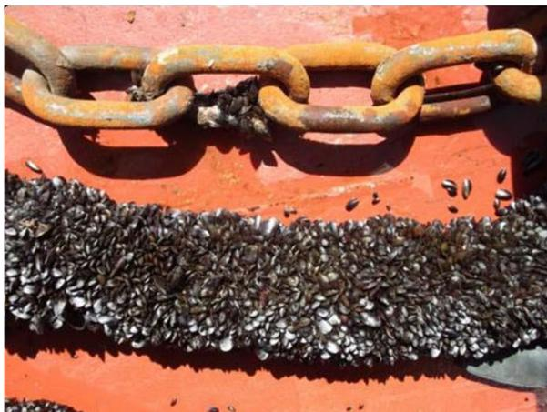
*Figura 2.1 – Sezione di catenaria post manutenzione e sezione di catenaria colonizzata da biofouling*
