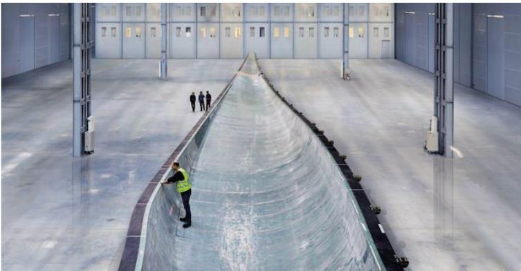
*Figura 7.62 – A sinistra: matrice di stampo per la realizzazione di una pala eolico per utilizzo offshore. In basso: la pala del generatore eolico Haliade-X 12MW (lunghezza 107 m).
