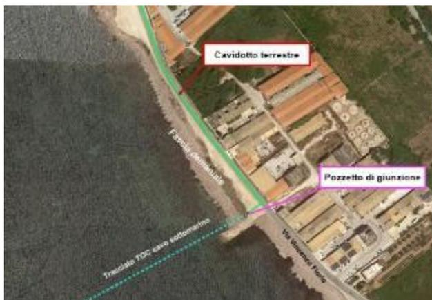
Alternativa nel PP della posizione del pozzetto di giunzione
