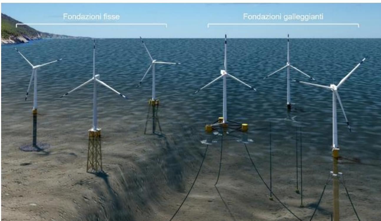
*Figura 7.1 – Illustrazione schematica delle diverse tipologie di fondazione.*
