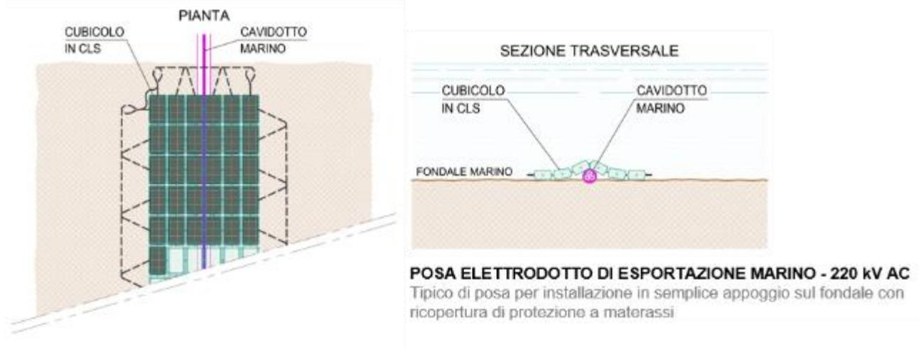
*Figura 7.95 – Tipico di posa dell'elettrodotto marino con protezione a materassi in cls.
