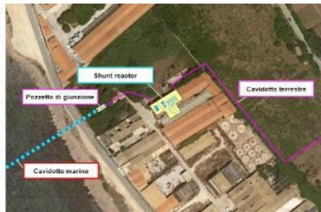
Alternativa nel PD della posizione del pozzetto di giunzione
