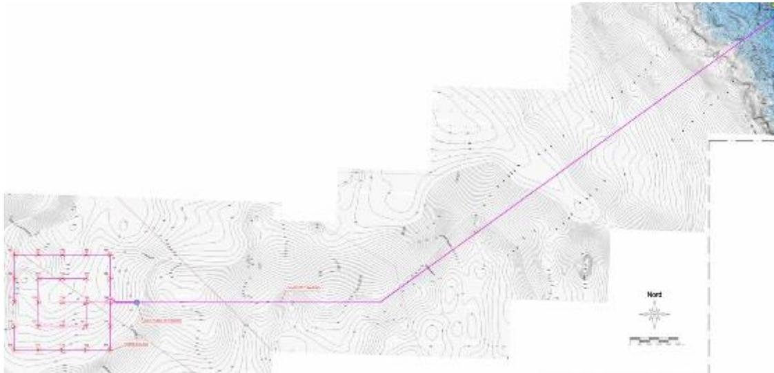
Figura 11.3 – Alternativa di percorso del cavidotto marino nel progetto preliminare su carta batimetrica Navionics (2019).
