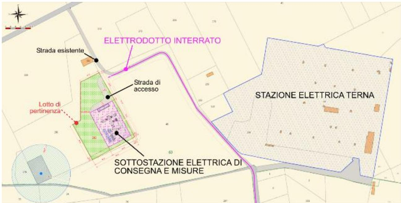
Figura 7.109 – Stazione TERNA individuata per la connessione alla rete nazionale nel territorio del comune di Partanna. Rappresentazione su planimetria catastale (Stralcio planimetrico da C0420.TT09.CONCAT.00). Elaborazione iLStudio.
