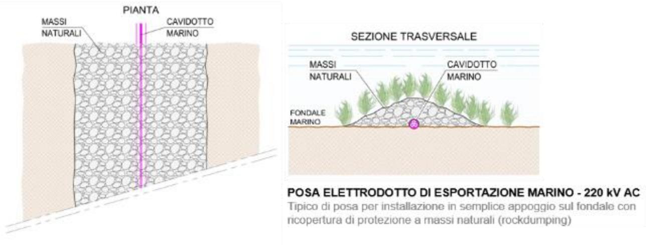
Figura 7.93 – Tipico di posa dell'elettrodotto marino con protezione in massi naturali.
