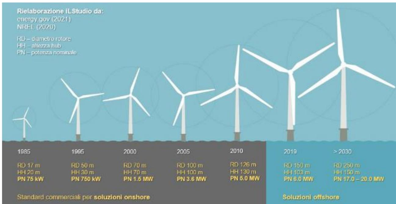
Figura 7.56 – previsione di crescita delle dimensioni degli aerogeneratori in termini di altezza hub, diametro rotore e potenza elettrica nominale. Soluzioni standard commerciali.
