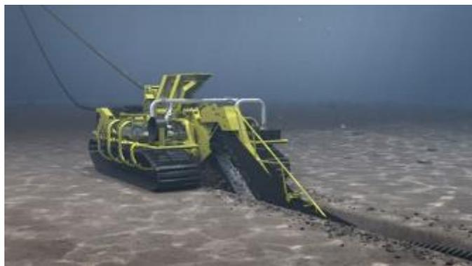
Figura 7.90 – Esempio di dispositivo per la posa in trincea del cavo.
