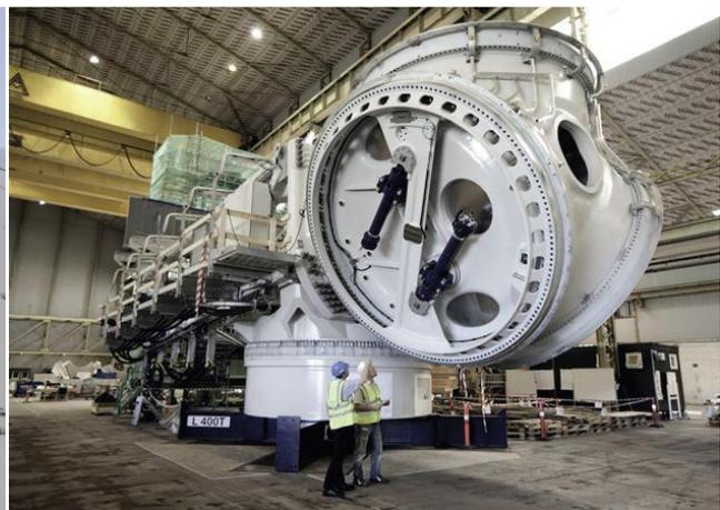
Esempio di sistema idraulico per la regolazione dell'angolo di pitch della pala.
