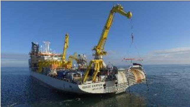
La posa del cavo di esportazione avviene mediante apposita imbarcazione posa cavo (MPSV/AHTS) che procede alla stesura muovendosi dalla costa verso la FOS. Successivamente, in relazione alla strategia di protezione del cavo, un mezzo dedicato procede all'applicazione di rocce/materassini o, mediante *trencher*, allo scavo, interrimento e ricopertura del cavo sempre muovendosi dalla costa verso il punto di allaccio alla FOS.
