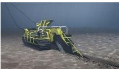
Esempio di dispositivo per la posa in trincea del cavo.
