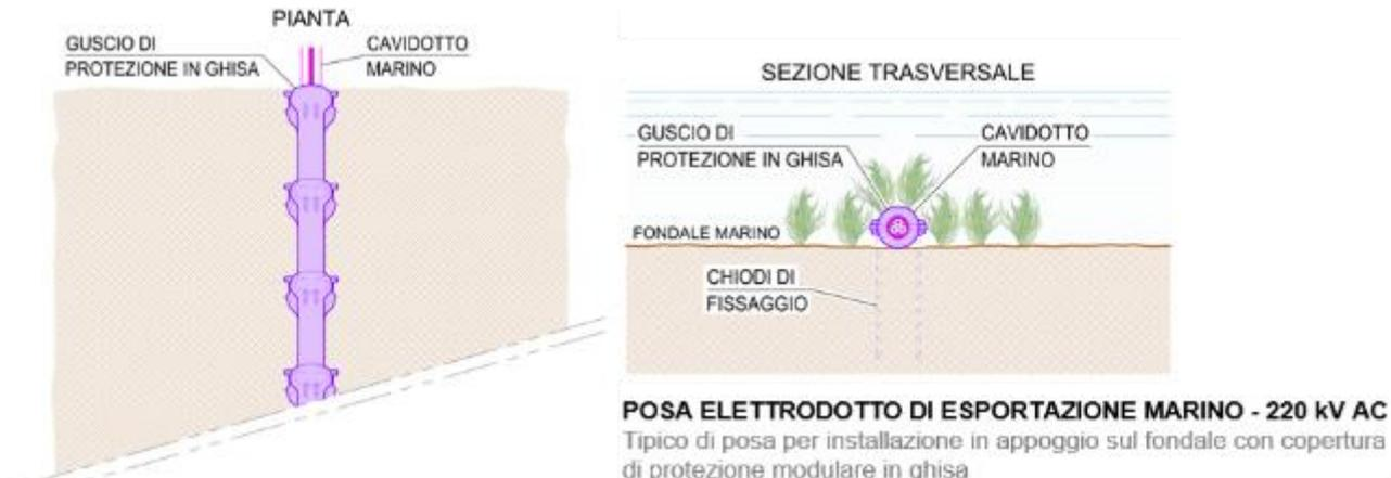
*Figura 7.97 – Tipico di posa dell'elettrodotto marino con protezione in elementi tubolari modulari.
