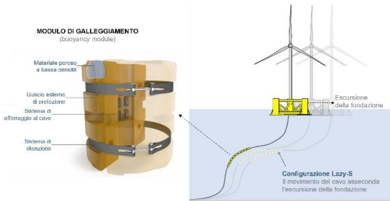
Figura 7.82 – configurazione Lazy-S del cavo. La presenza dei moduli di galleggiamento consente di realizzare una “riserva di cavo” che compensa l'escursione della fondazione galleggiante riducendo la sollecitazione sul cavo.
