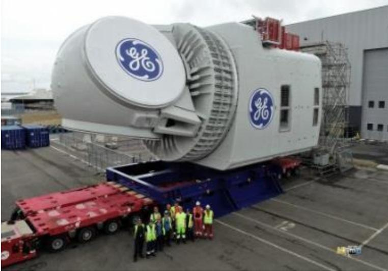
*Figura 7.65 – navicella di un aerogeneratore Haliade-X di General Electric.*
