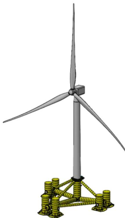
Figura 5.2 - Fondazione galleggiante SOT – Tetrasub con installato aerogeneratore tripala
