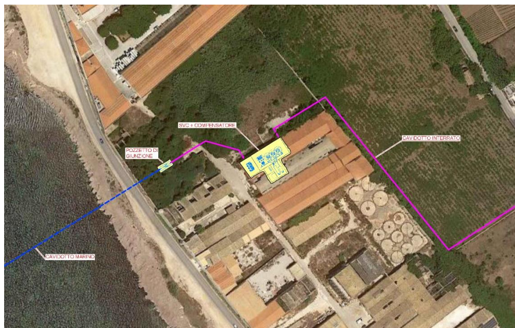
Figura 5.6 - Punto di sbarco cavidotto marino, punto di giunzione (TJB) e sezione iniziale del cavidotto terrestre
