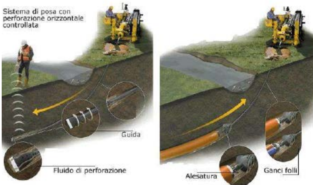
Posa in opera tubazione con trivellazione teleguidata
