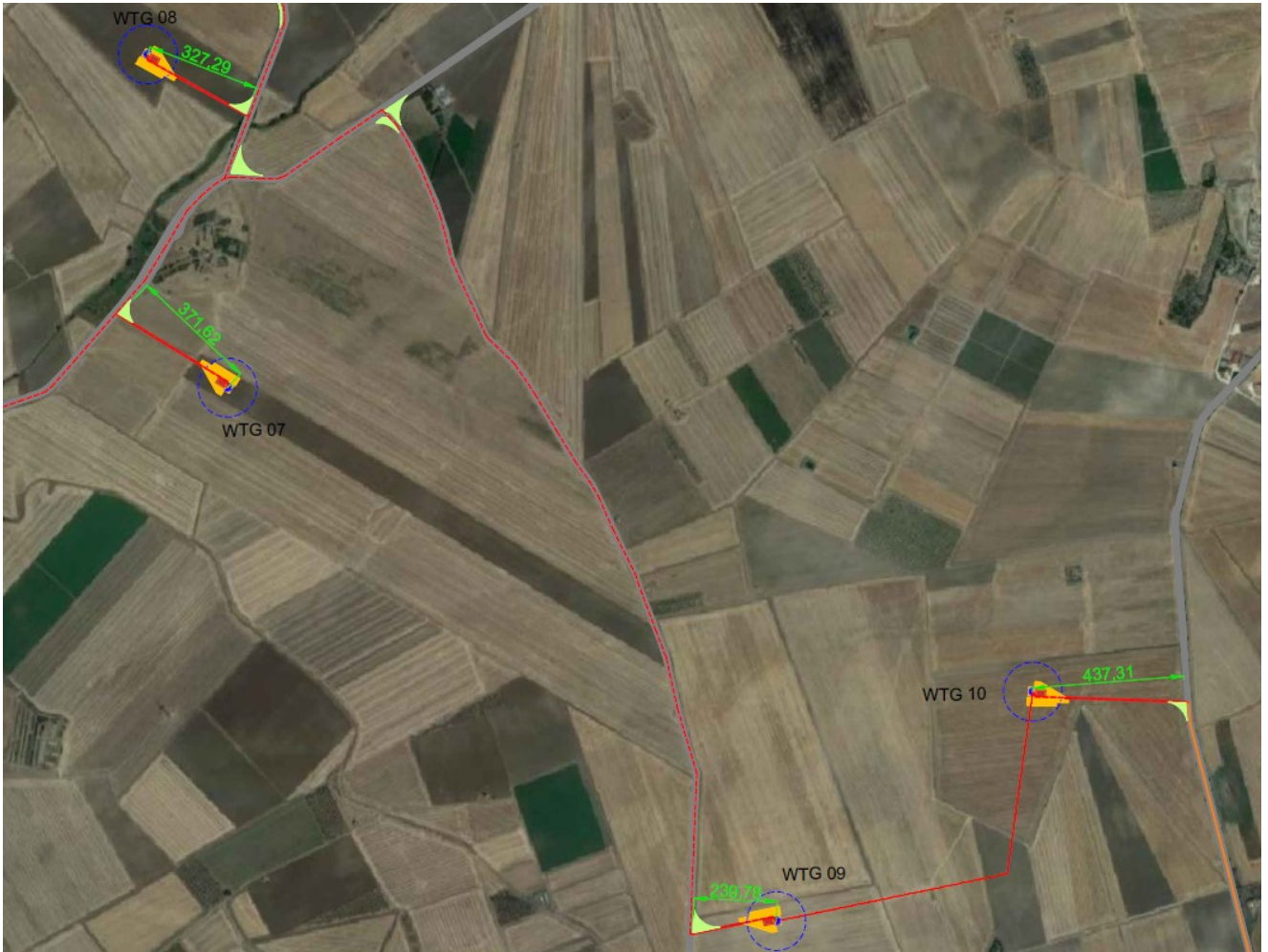
Distanza dalle strade degli aerogeneratori
