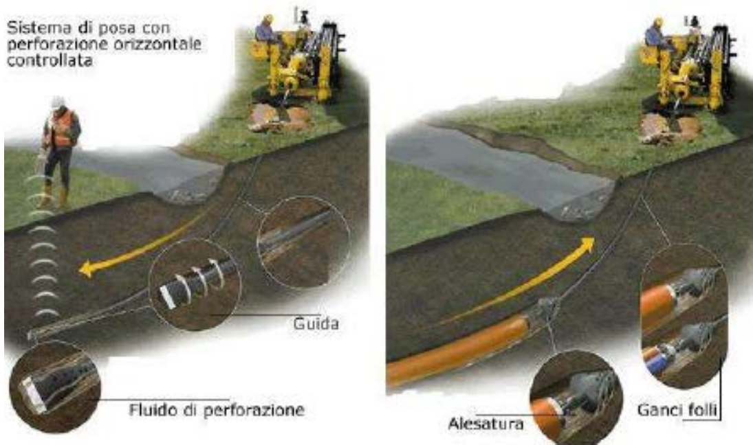
Posa in opera tubazione con trivellazione teleguidata
