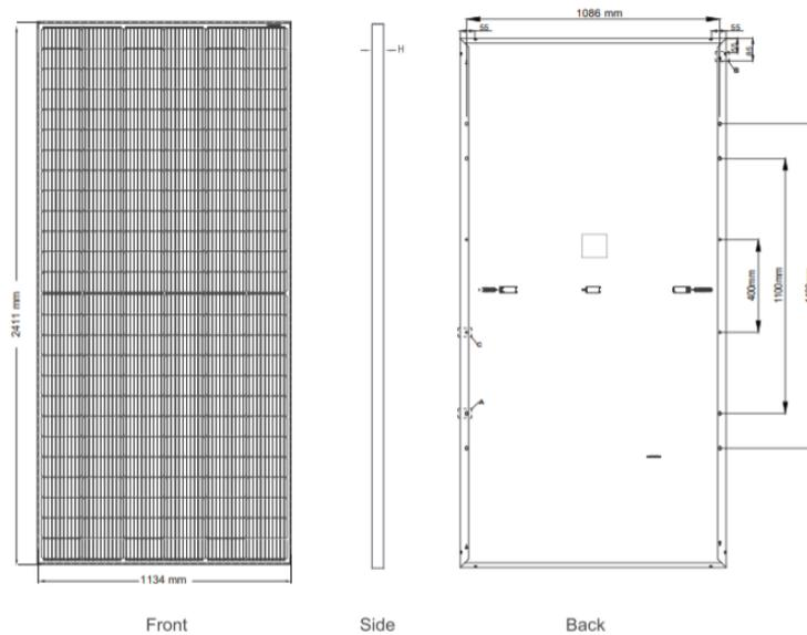
Figura 91- Pannello Jinko Solar modello JKM585M.
