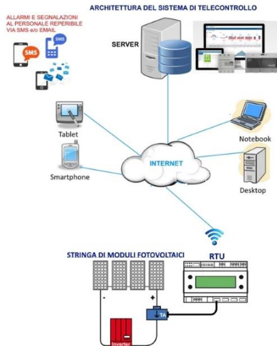
Figura 135 - Schema sistema di telecontrollo
