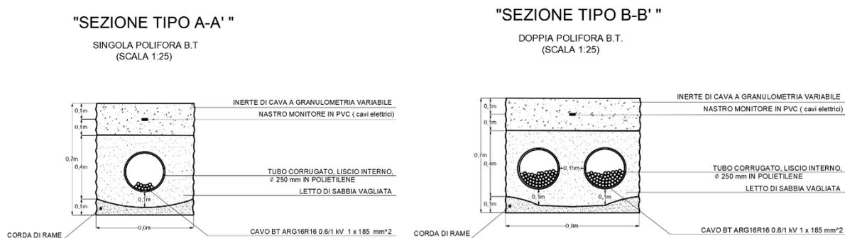
Figura 100- Cavidotti BT interni
