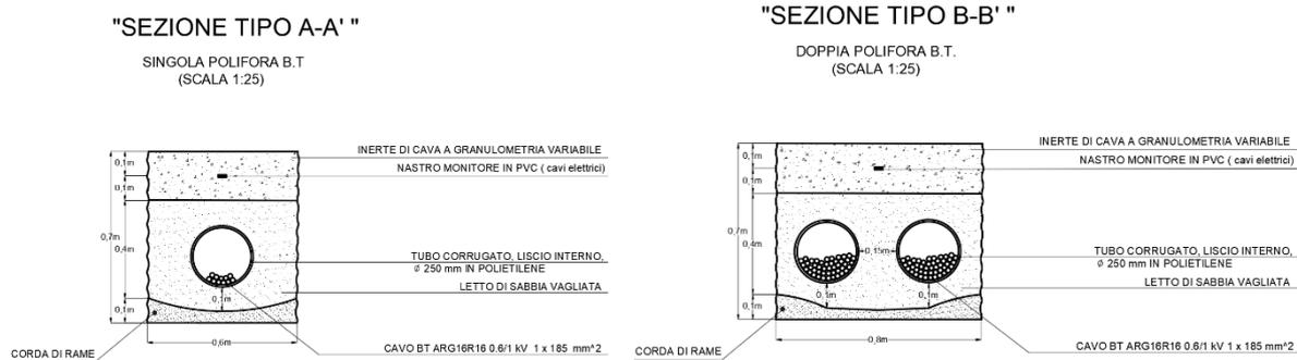
Figura 115 - Sezione tipo di elettrodotto BT
