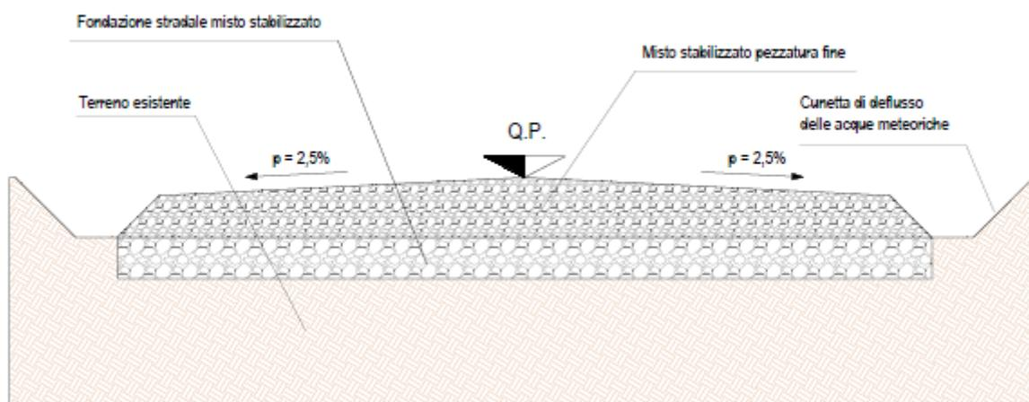
Figura 114- Sezione-tipo strade interne in misto stabilizzato
