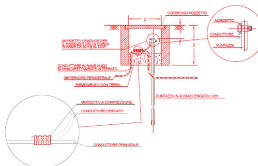
Le sezioni dei conduttori di protezione saranno pari alle sezioni dei conduttori di fase; per sezioni superiori a 16 mm<sup>2</sup> la sezione è pari alla metà del conduttore di fase con un minimo di 16 mm<sup>2</sup> e comunque in grado di soddisfare le condizioni stabilite dalle norme CEI 64.8.
