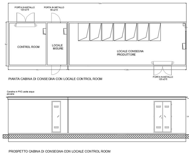
*Figura 96- Cabina di raccolta e control room*
