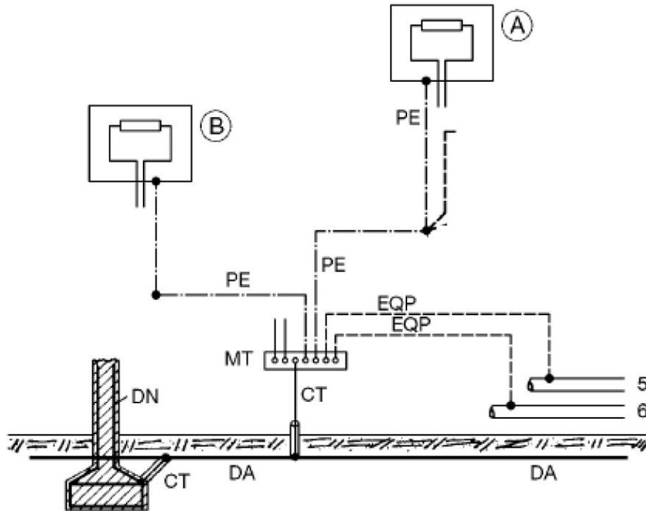
Figura 101 - Esempio di impianto di terra
