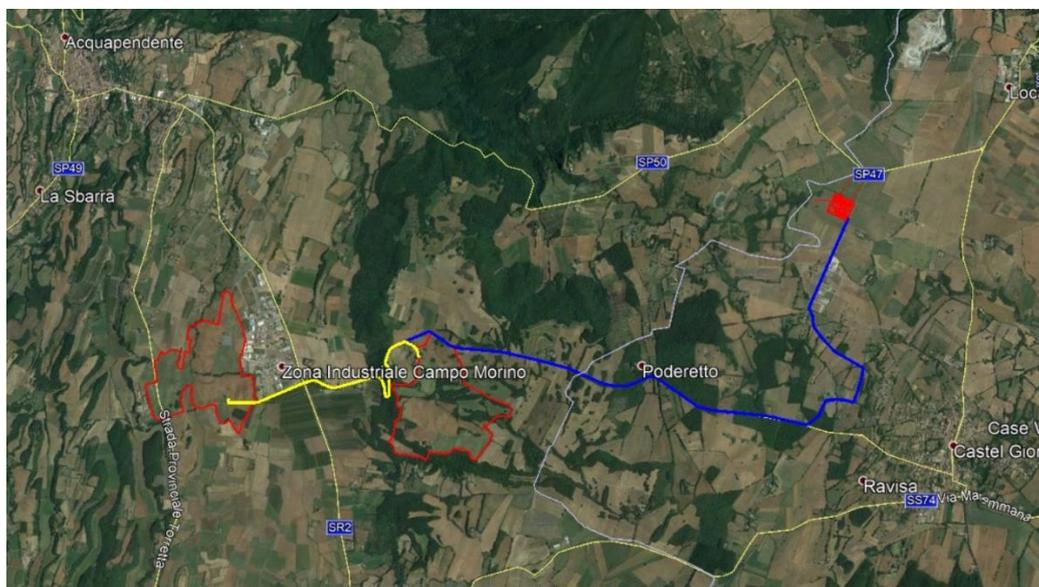
*Figura 97- Tracciato del caviodotto MT esterno verso la nuova SE*
