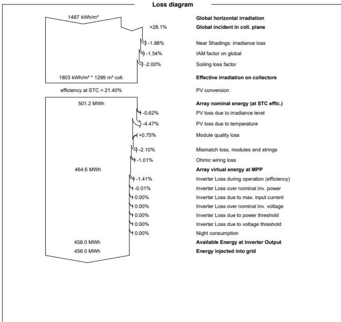
Figura 106 - Simulazione producibilità, perdite
