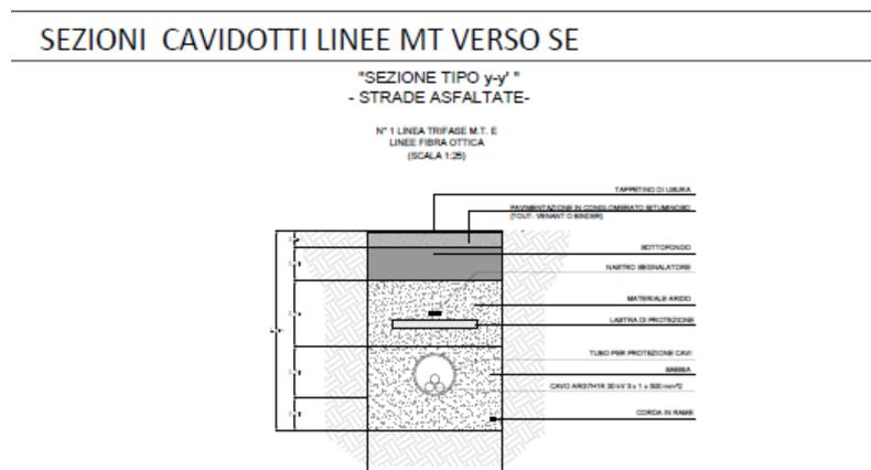
Figura 99- Sezione tipo cavidotto esterno MT
