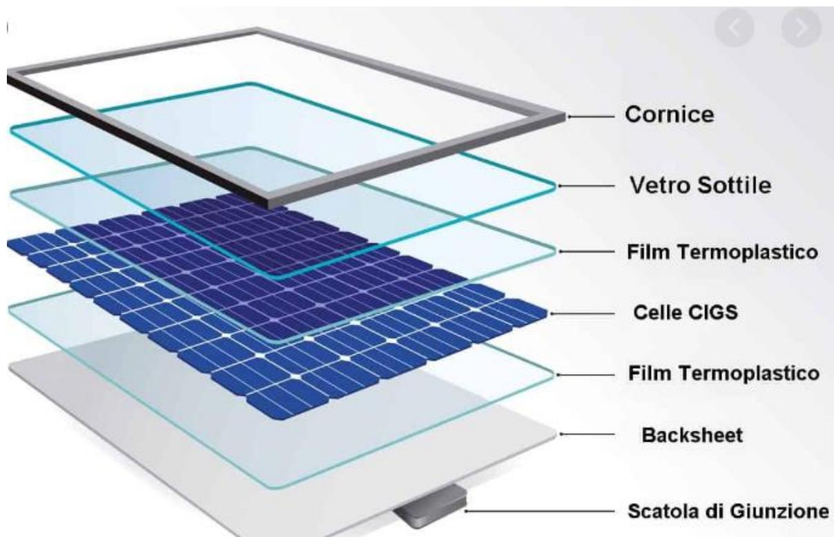
Figura 75- Pannello fotovoltaico
