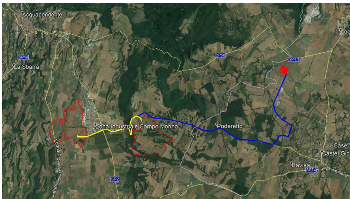
Fig. 10: Tracciato cavidotto MT esterno verso SE
