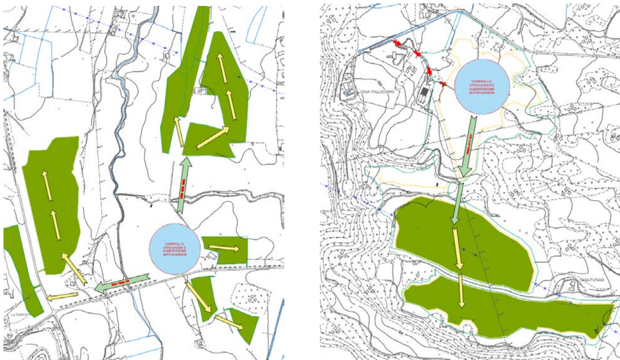
Fig.2- Schema concettuale dislocazione cantieri e alimentazione sottocantieri
