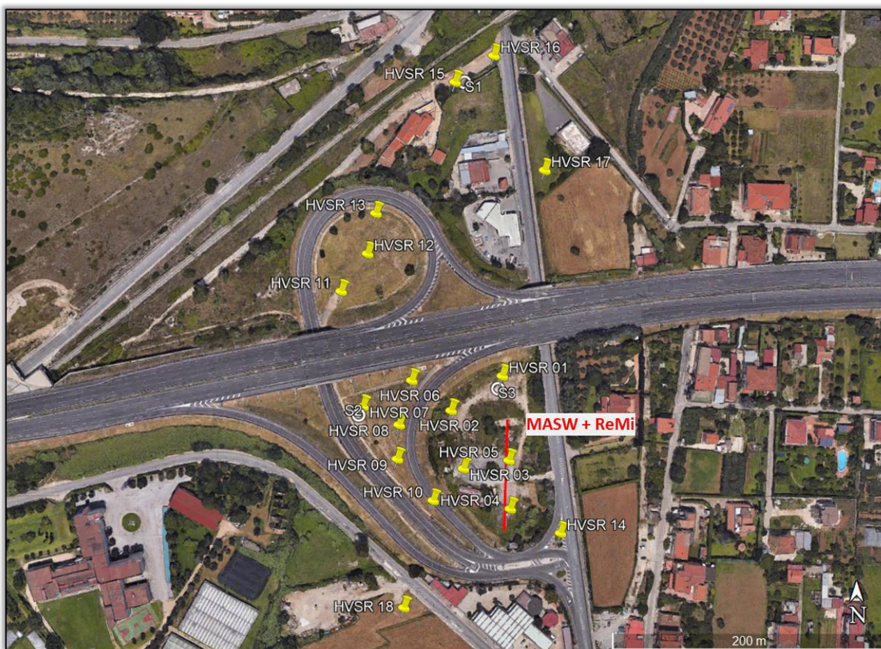
Figura 4: ubicazione indagini geofisiche
