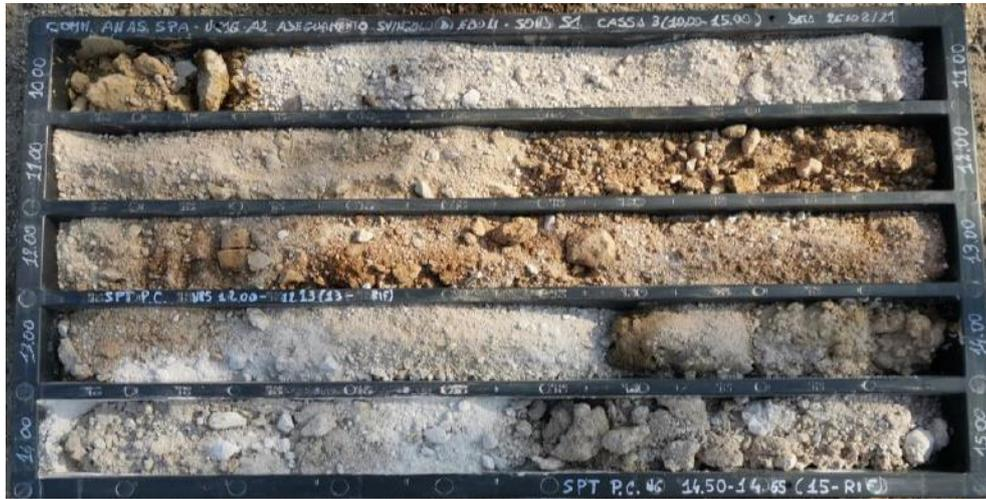
Figura 9 Particolare delle ghiaie in matrice sabbiosa (Ga) carotate nel sondaggio S01 tra 10 e 15 m di profondità
