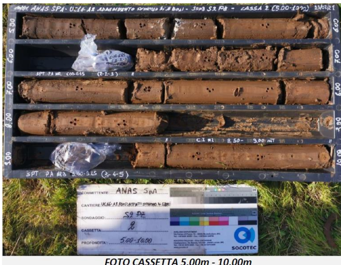
Figura 12. Foto cassetta n.2 da 5.0 a 10.0 m sondaggio S2
