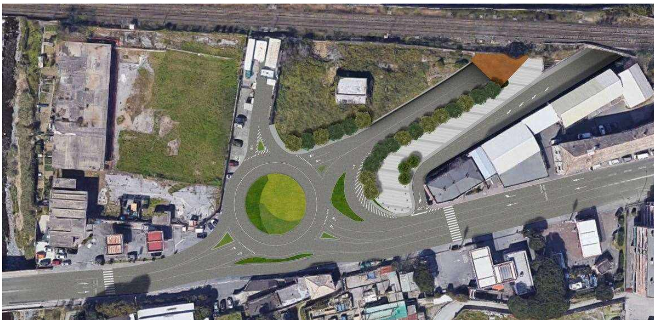
Figura 3-13. Foto inserimento area sud: uscita a 'mare' galleria artificiale e immissione su SS 1 Aurelia
