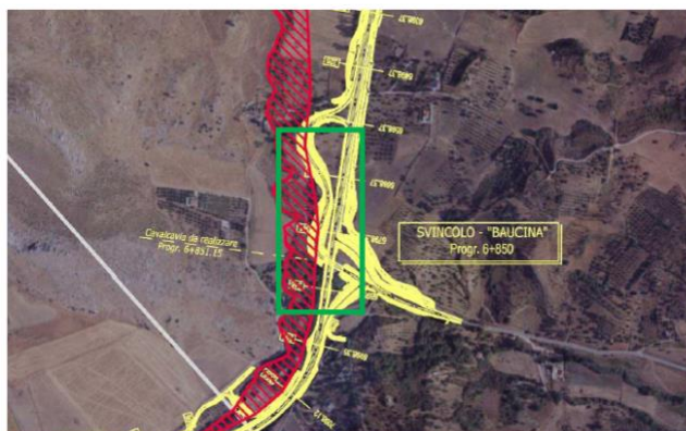
Figura 52 Localizzazione opera (in verde) e dell’area esondazione Novembre 2018 (tratteggio inrosso)
