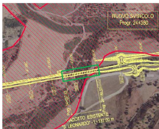
Figura 13 Localizzazione opera (in verde) ed esondazione Novembre 2018 (tratteggiato rosso)
