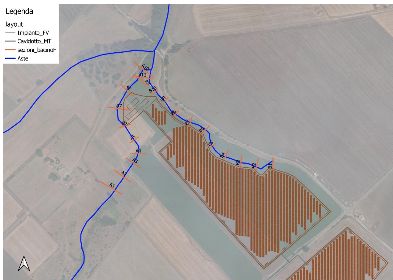
Figura 5: Planimetria dei corsi d'acqua analizzati con l'individuazione delle sezioni trasversali rilevate
