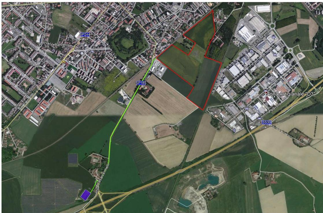
**FIGURA 2 IMMAGINE SATELLITARI DELL'AREA OGGETTO DI INTERVENTO CON INDIVIDUAZIONE DELL'AREA DI INSTALLAZIONE DELL'IMPIANTO E DI CAVIDOTTO INTERRATO E CABINA DI CONSEGNA**
