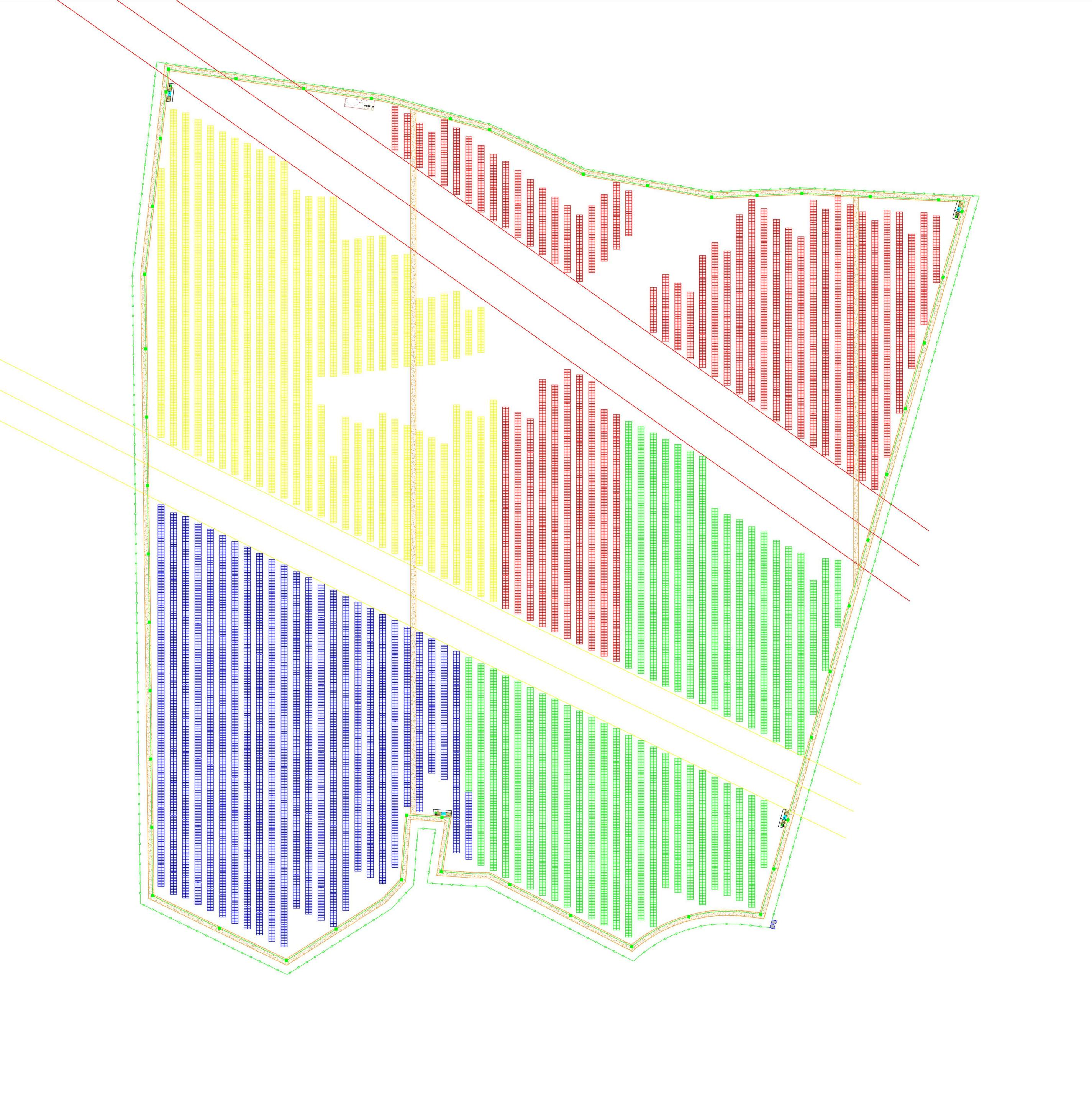
CONFIGURAZIONE tracker interasse 9 735 traker 2P42 da 84 moduli = 61740 94 traker 2P28 da 56 moduli = 5264 67004 pannelli 67004\*545=36.51718 MW
