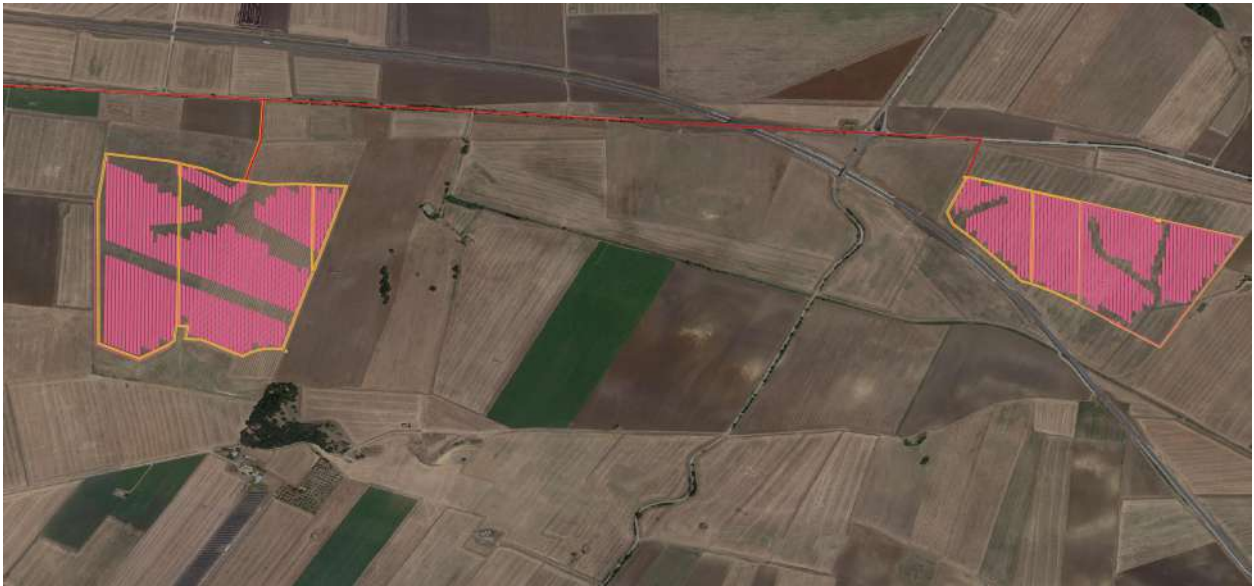
Figura 1 - Planimetria generale dell'impianto fotovoltaico
