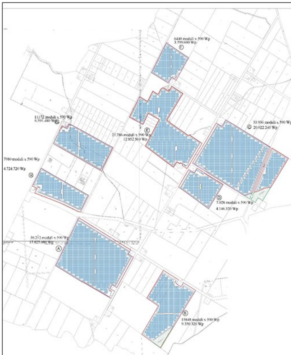
Figura 1: layout Impianto su base catastale
