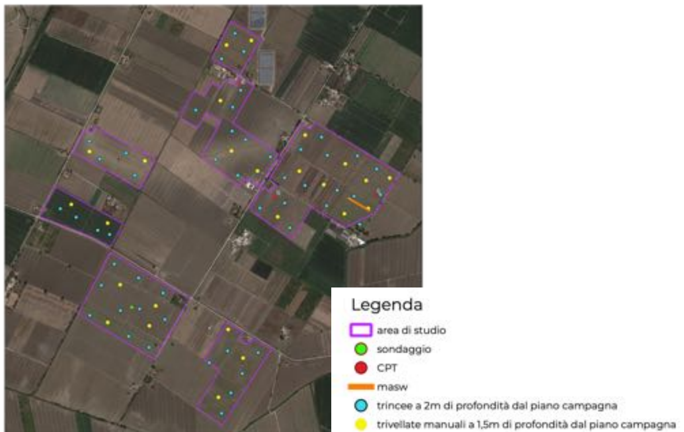
Figura 8: Ubicazione indagini geognostiche realizzate
