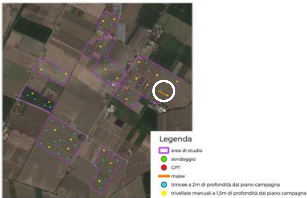
Figura 14: Indagine sismica MASW realizzata il 07/05/2021
