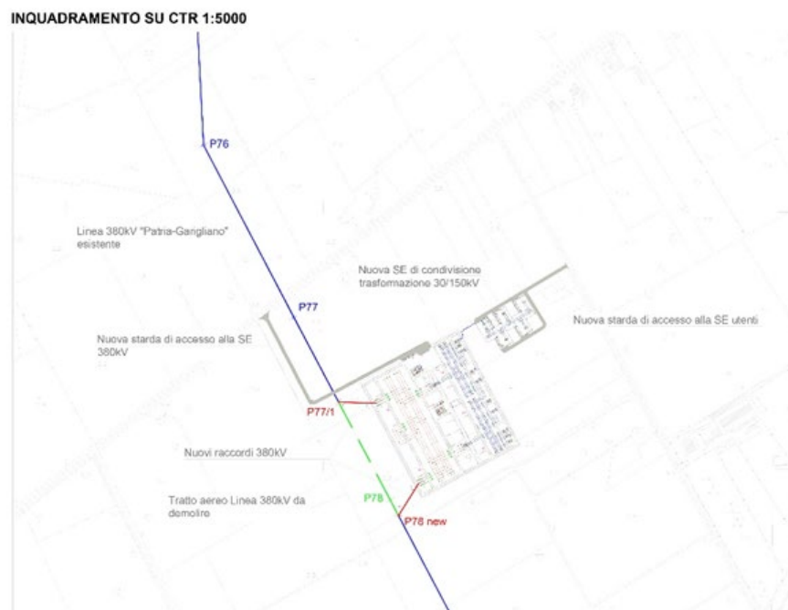
Figura 36: layout Stazione Elettrica - Sottostazione Elettrica
