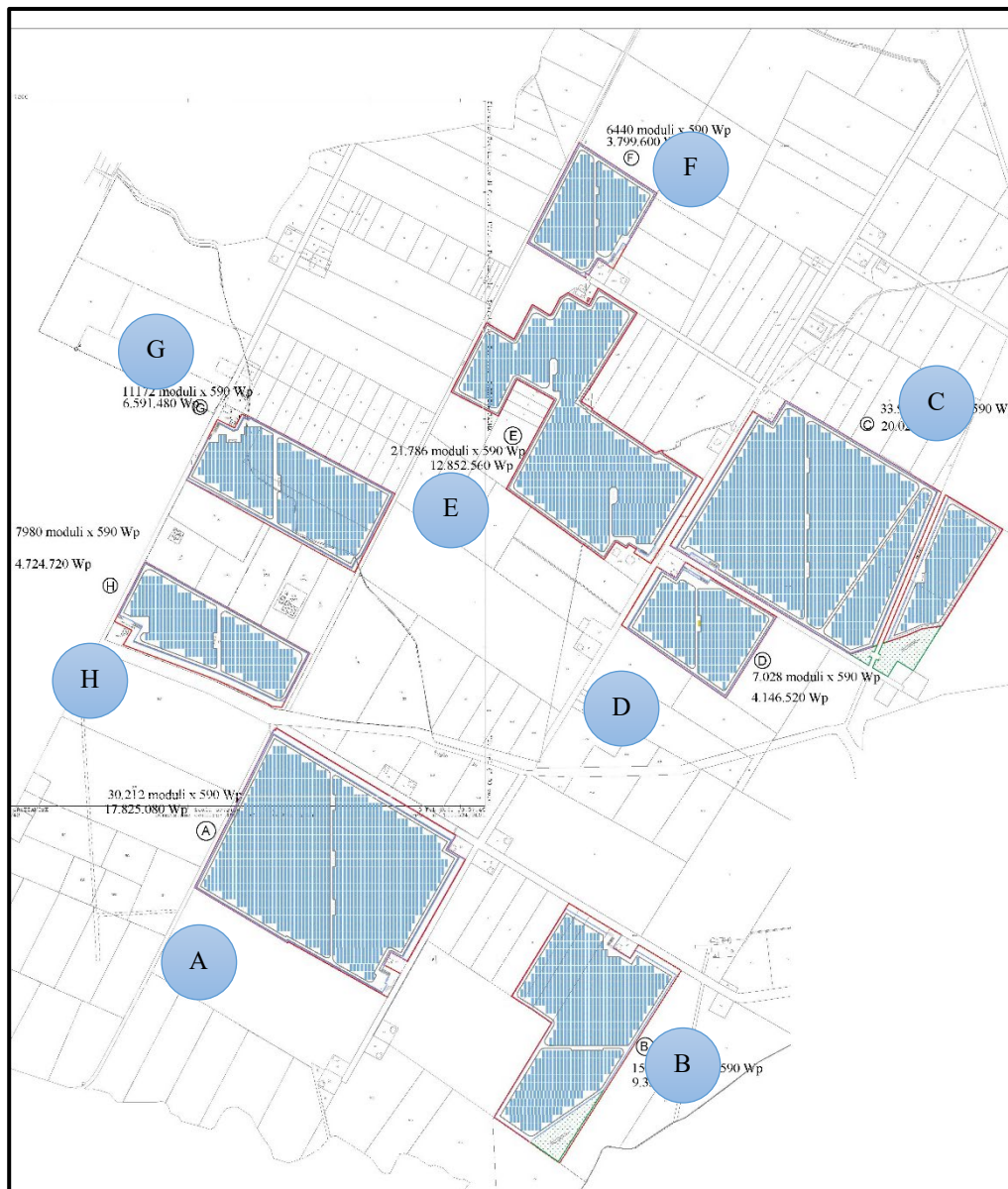
Figura 33: Layout Impianto su base catastale
