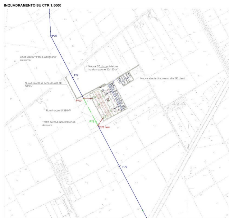
Figura 3: Layout Stazione Elettrica - Sottostazione Elettrica
