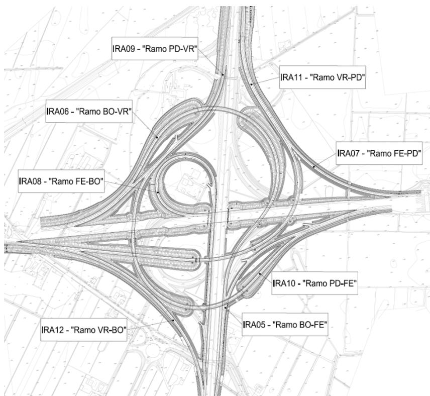
**Figura 2.1.1.3-1** – Schema planimetrico svincolo interconnessione con l'Autostrada A13
