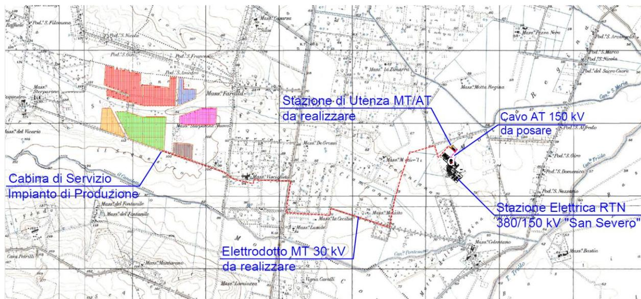
Figura 4.9: In rosso il percorso di connessione dal campo FV alla cabina di trasformazione
