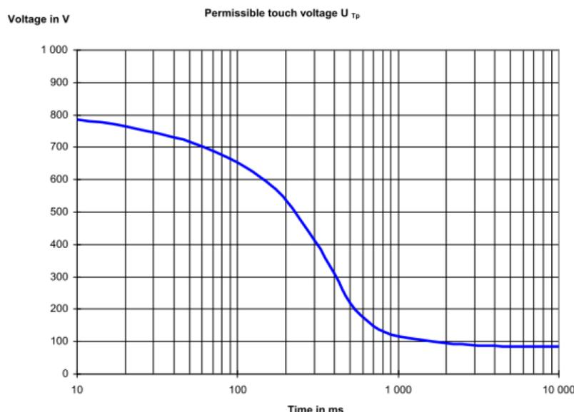
Figura 5.1: Massima tensione ammissibile (CEI EN 50522, Fig.4).
