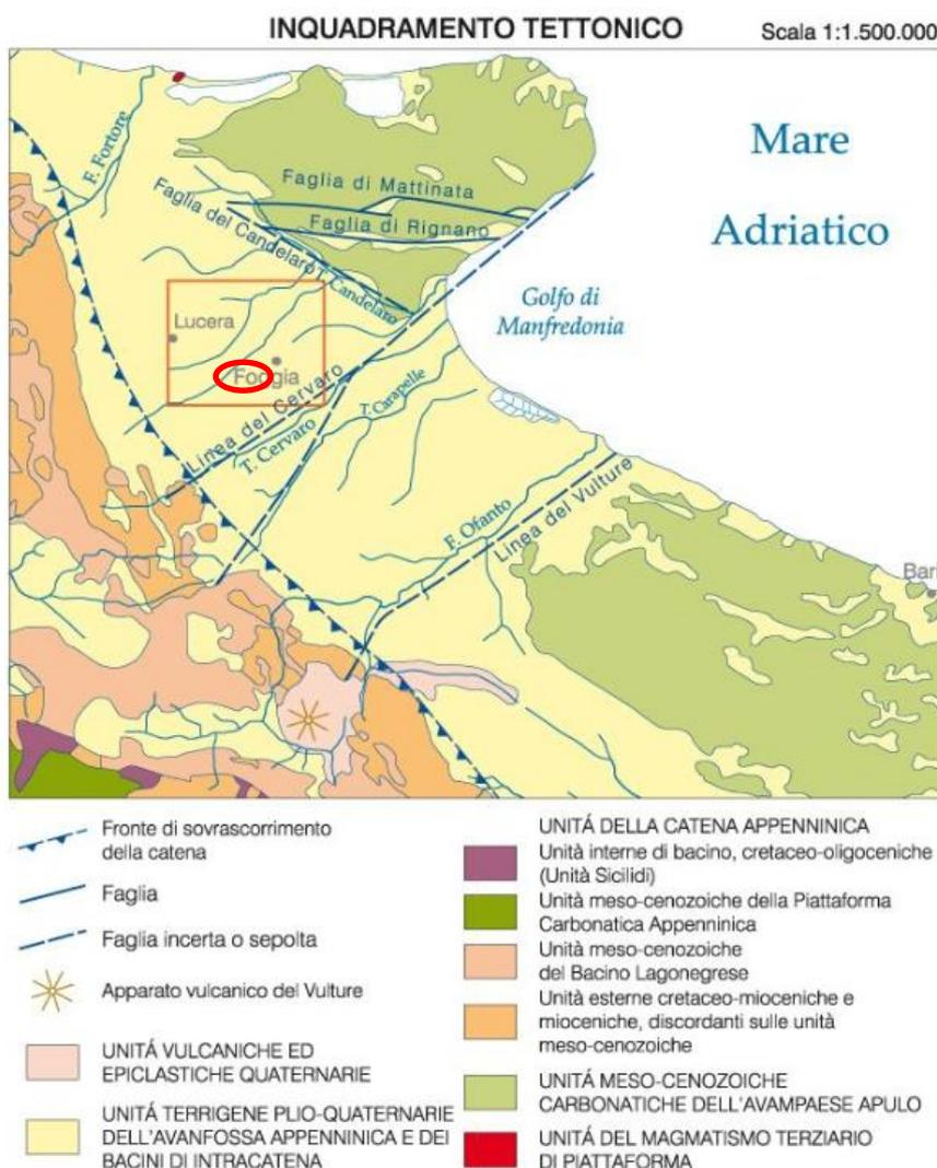
Figura 3.1: Schema geologico e strutturale dell'area del Tavoliere e del Subappennino Dauno – Area di cantiere nel cerchio rosso
