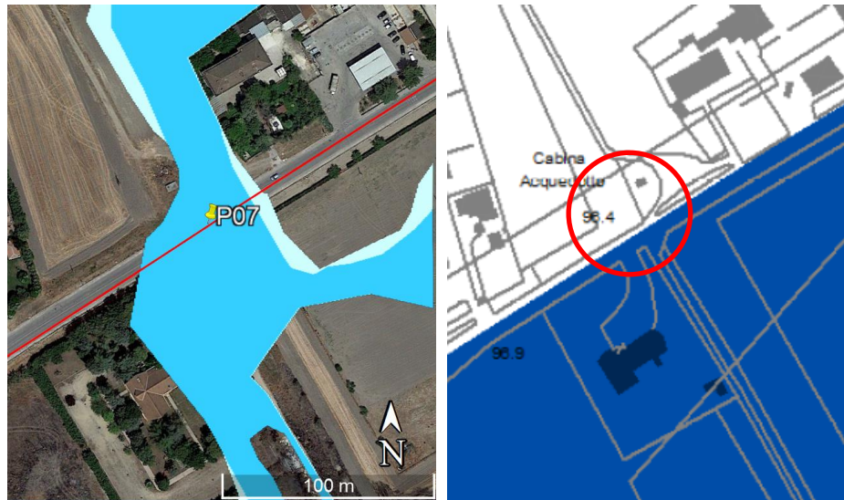
Figura 5.21: A sinistra stralcio del PAI con fasce di pericolosità idraulica Media e Bassa. A destra stralcio del PGRA foglio nr. 121 “Foggia” con fascia di pericolosità idraulica alta (blu).
