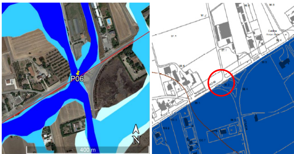
Figura 5.19: A sinistra stralcio del PAI con fasce di pericolosità idraulica Alta, Media e Bassa. A destra stralcio del PGRA foglio nr. 121 "Foggia" con fascia di pericolosità idraulica alta (blu).
