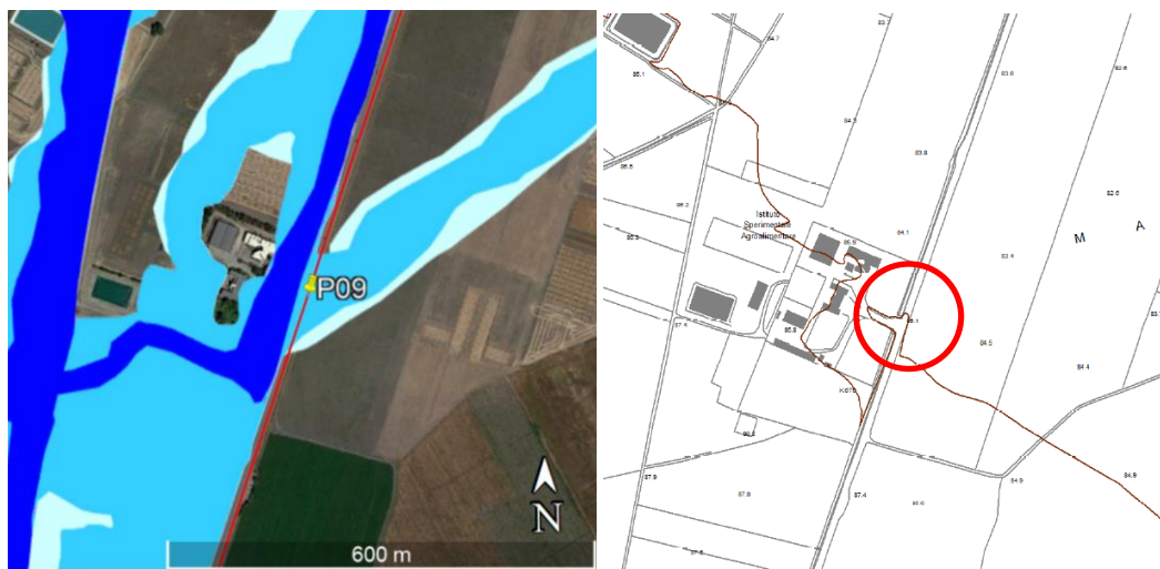
Figura 5.25: A sinistra stralcio del PAI con fasce di pericolosità idraulica Media e Bassa. A destra stralcio del PGRA foglio nr. 121 “Foggia” che non presenta alcuna fascia di pericolosità idraulica.
