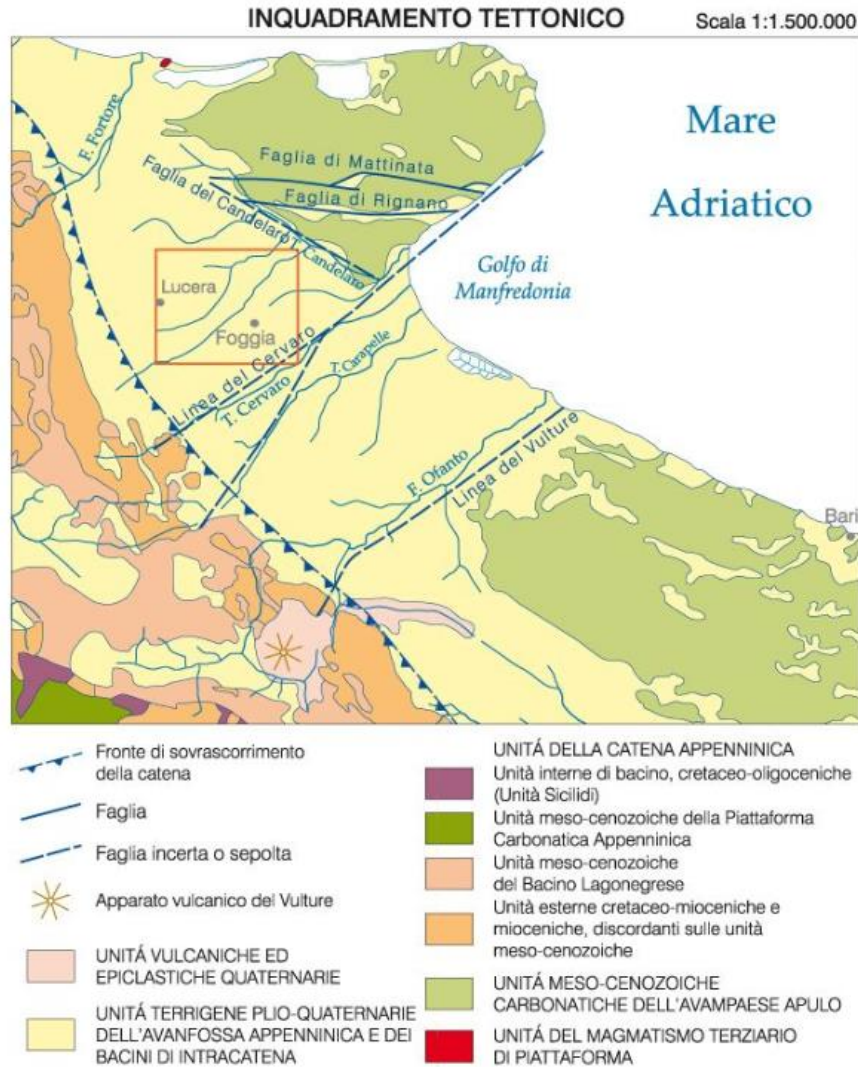
Figura 3.4: Schema geologico e strutturale dell'area del Tavoliere e del Subappennino Dauno – Area di cantiere nel cerchio rosso.
