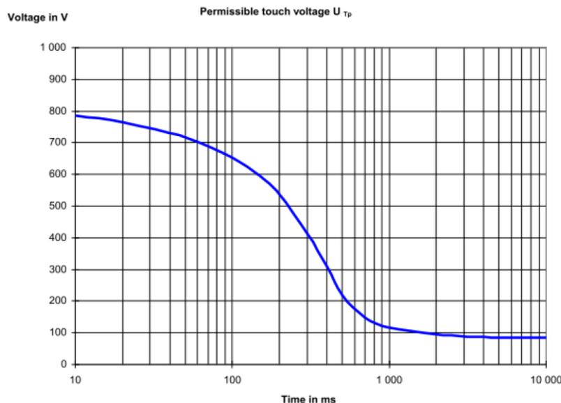
Figura 7.1: Massima tensione ammissibile (CEI EN 50522, Fig.4).
