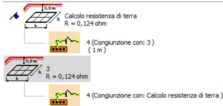
Figura 7.4: Calcolo della resistenza di terra globale
