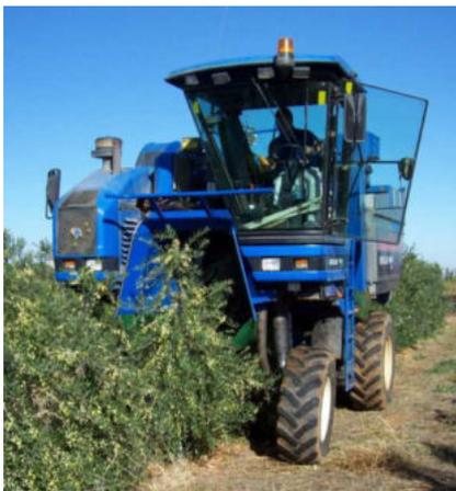
Fig.10: Macchina scavallatrice
