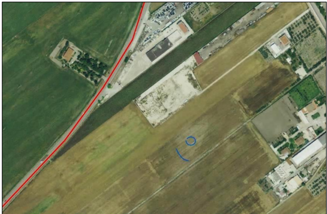
Mappatura delle anomalie individuate (in azzurro) in relazione alle opere in progetto (in rosso).
