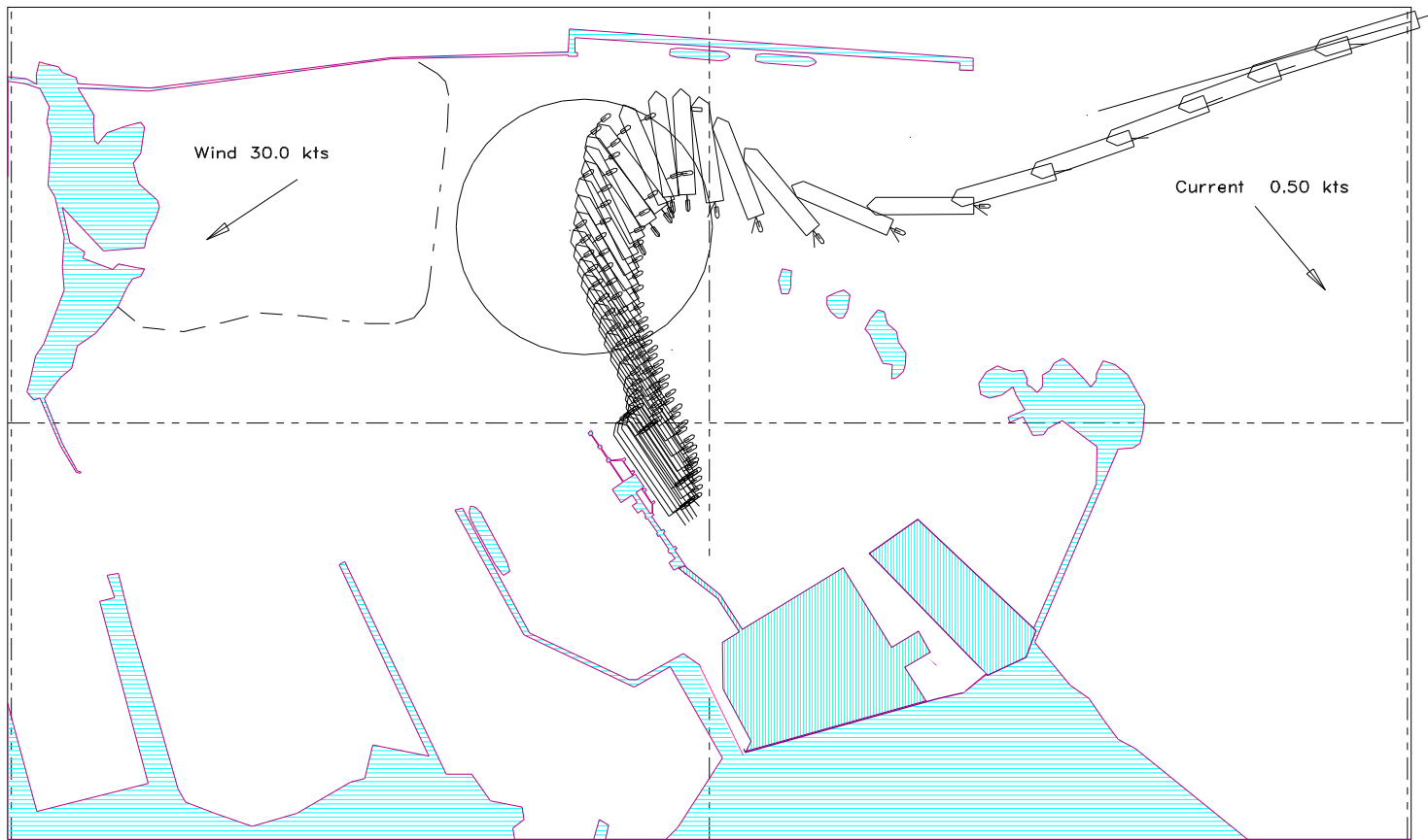
Brindisi (2) 137,000 m**3 M LNG Carrier. Run 5
