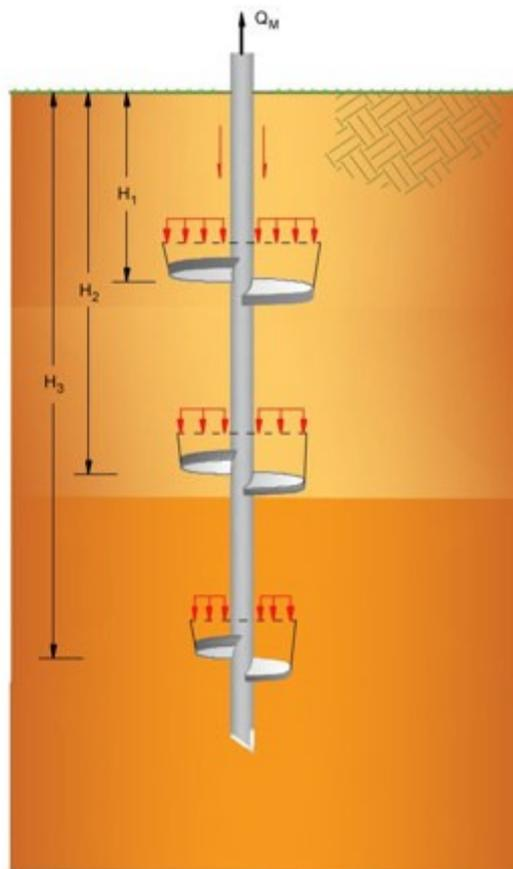
La capacità portante di un sistema multielica si ottiene dalla somma delle resistenze a compressione sulle singole eliche.
