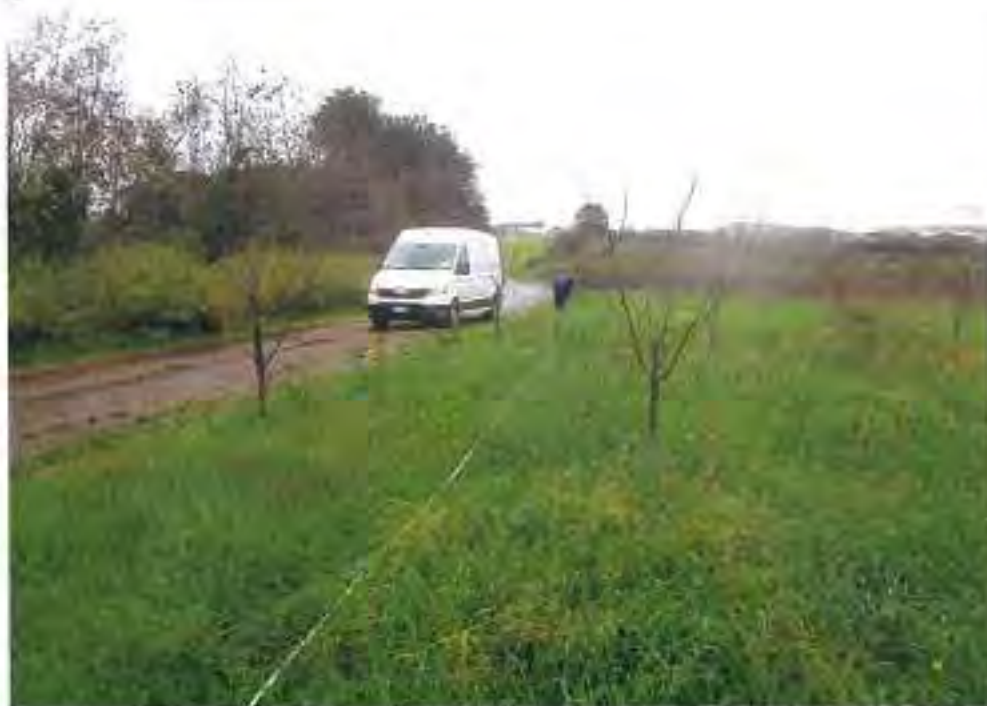
Esecuzione profilo sismico a rifrazione 3-3'
