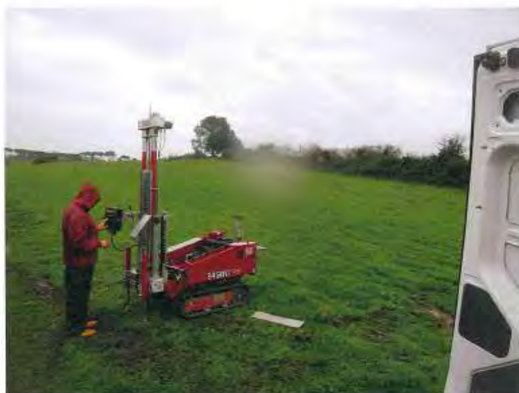
Esecuzione prova DPSH 1
