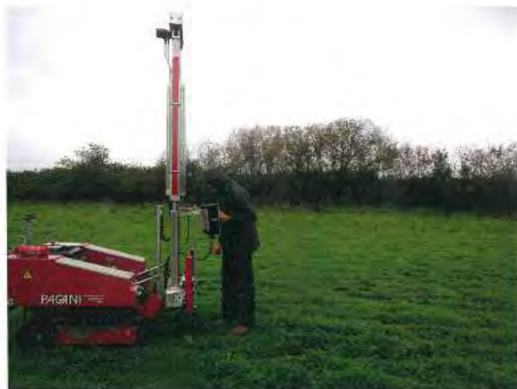
Esecuzione prova DPSH2
