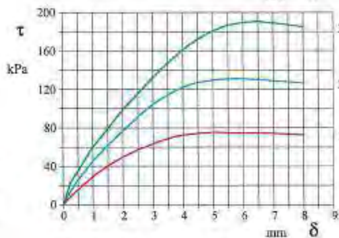
DIAGRAMMA Tensione - Deformaz. orizz.
