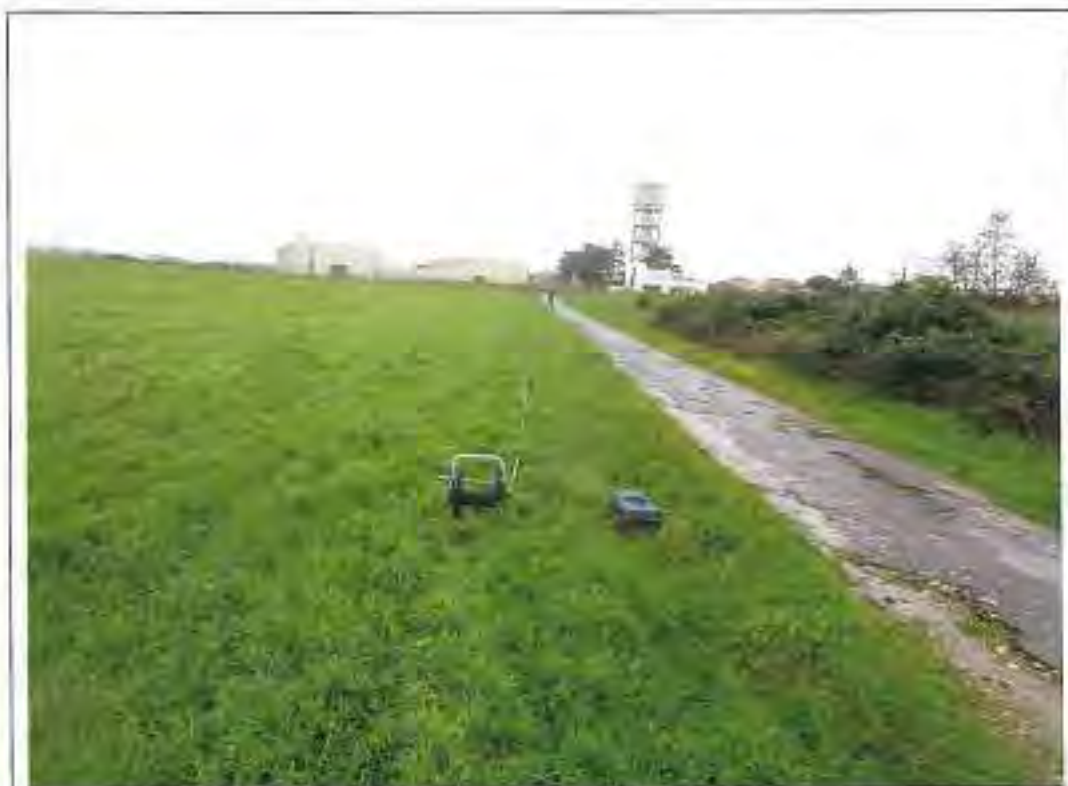
Esecuzione profilo sismico a rifrazione 1-1'
