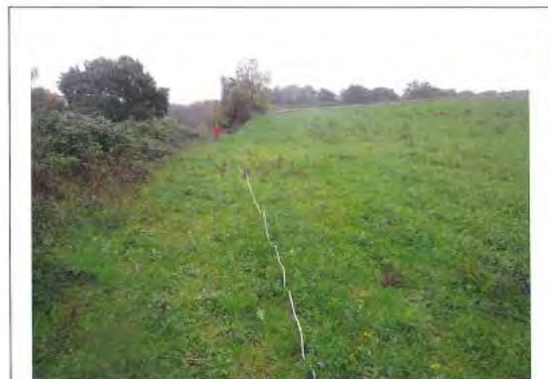
Esecuzione profilo sismico a rifrazione 5-5'
